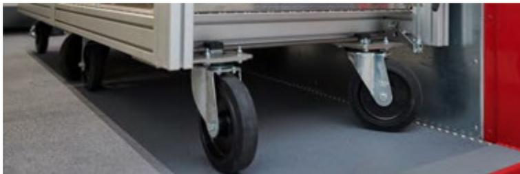
Abbildung 37: Ladeflächenboden kunststoffbeschichtet.
