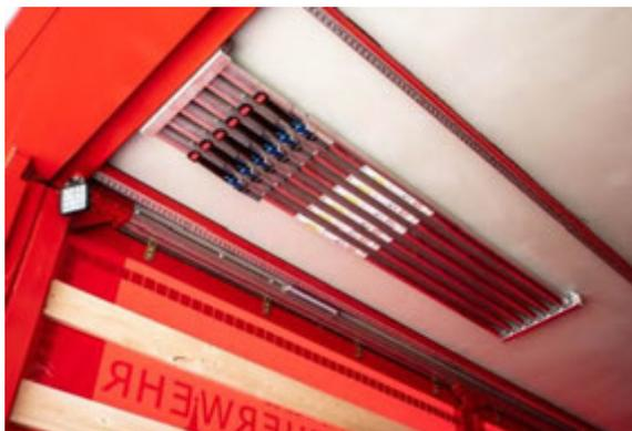
Abbildung 28: Teleskopsperrstangen mit Depot im Dachbereich.
