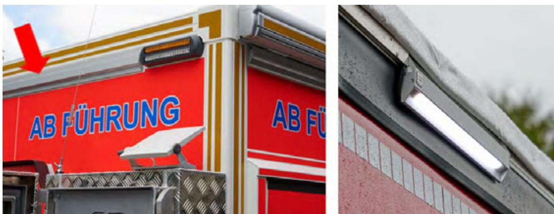
Abbildung 44: LED-Lichtstreifenelement Fabr. LDR, vorn und seitlich.
