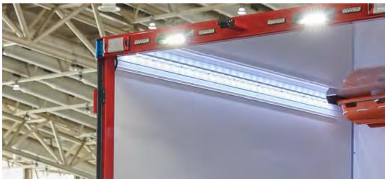
Abbildung 42: LED-Laderaumbeleuchtung (hier bei Ausführung Kofferaufbau).
