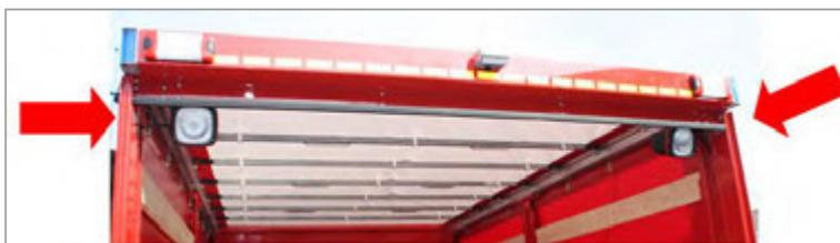
Abbildung 40: LED-Arbeitsstellenscheinwerfer im Heckportal, schwenkbar.
