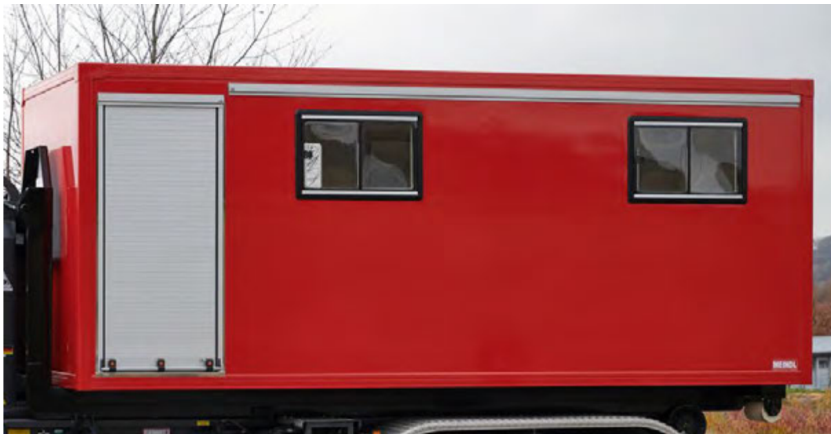
Abbildung 1: AB Besprechung mit vorderen abgetrennten Geräteräumen mit Rollläden, Kunststoff-Sandwichbauweise. LED-Umgebungsbeleuchtung über die gesamte Aufbaulänge.
