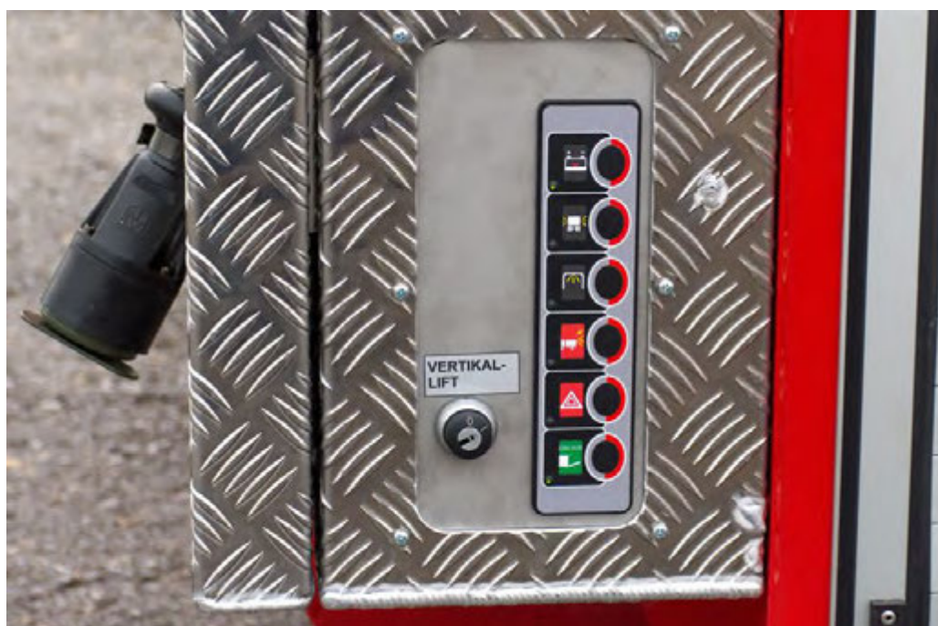
Abbildung 25: Detail – CAN-BUS gesteuerte Zentralelektrik, Standard-Bedienteil mit Notbedienfunktion bei Unterspannungsauslösung, Steuerung für Beleuchtung und ggf. zusätzliche Verbraucher.
