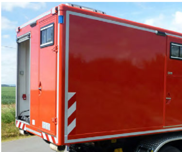
Abbildung 61: Kontur- und DIN-Warnmarkierung.
