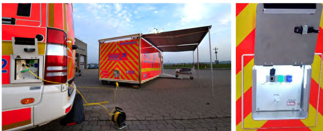
Abbildung 47: Verbindung ELW-1 zu AB Führung, Detail – MEINDL-Übergabeeinheit.
