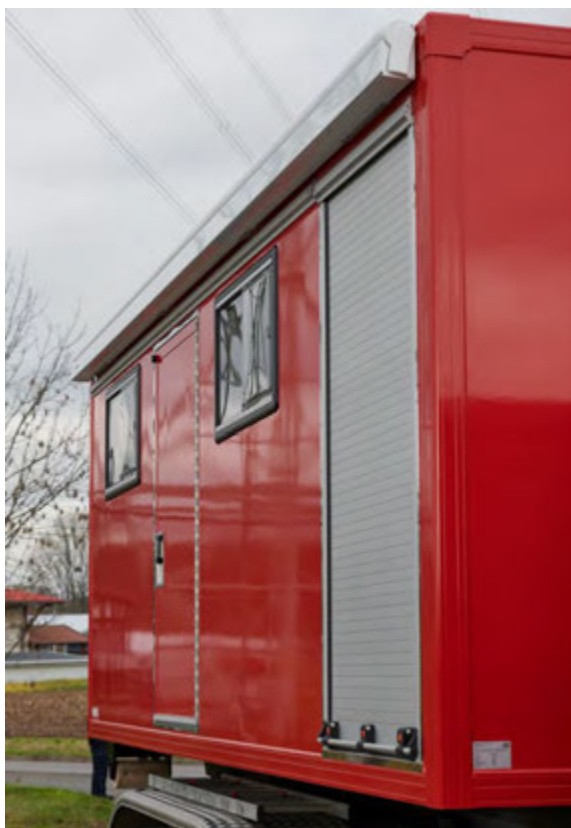
Abbildung 2: AB Besprechung mit seitlich aufgesetzter Markise über die gesamte Aufbaulänge.
