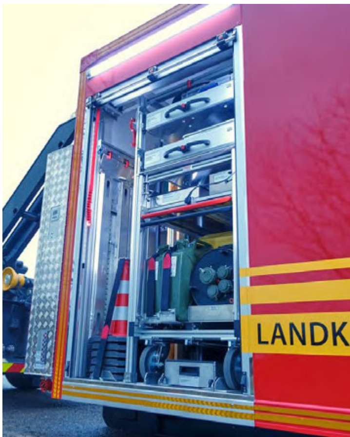
Abbildung 5: Detail – Vorderer separater Geräteraum mit Regalanlage.
