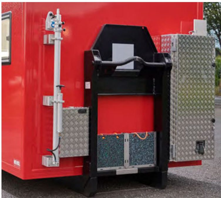
Abbildung 35: Entkoppelter Aufnahmebügel mit großflächigem Anstoßschutz.
