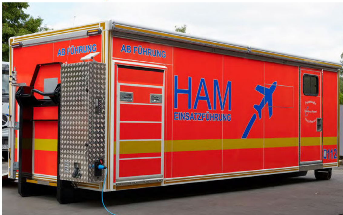
Abbildung 7: AB Führung mit vorderen abgetrennten Geräteräumen mit Rollläden, Kunststoff-Sandwichbauweise. LED-Umfeldbeleuchtung über die gesamte Aufbauhöhe sowie vorne und hinten über die gesamte Breite. Seitlich aufgesetzte Markise über die gesamte Außenlänge (die Grundbreite des Behälters muss dafür geringer sein, dadurch Verringerung der lichten Breite innen).
