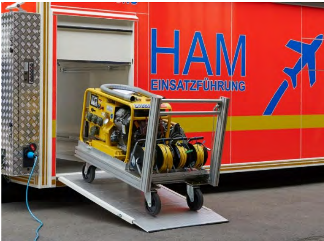
Abbildung 12: Detail – Laderampe des vorderen Geräteraumes, MEINDL-Rollcontainer.
