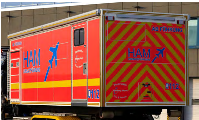
Abbildung 62: Heckschraffur-Kennzeichnung, seitliche Konturmarkierung, Beschriftung nach Vorgabe.
