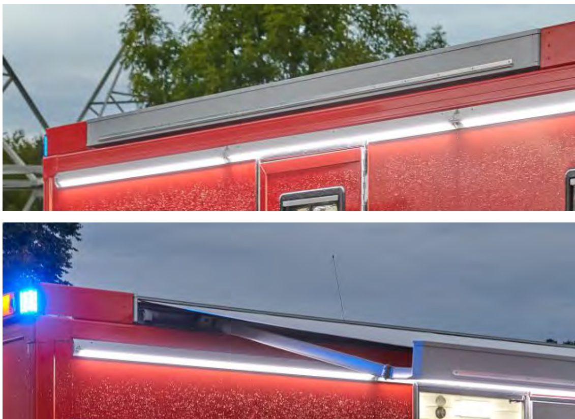
Abbildung 59: Freitragende 230-Volt-Haustechnik-Markise, auf dem Dach in der Dachgalerie bündig integriert.
