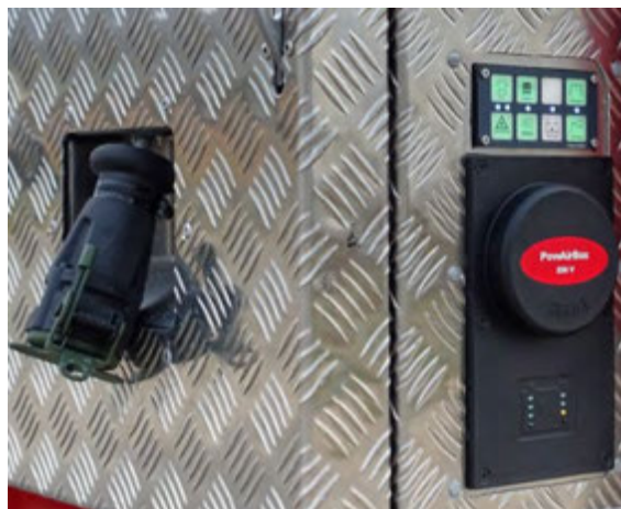
Abbildung 33: Stromeinspeisung PowAirBox, alternatives Bedienteil inomatic®.
