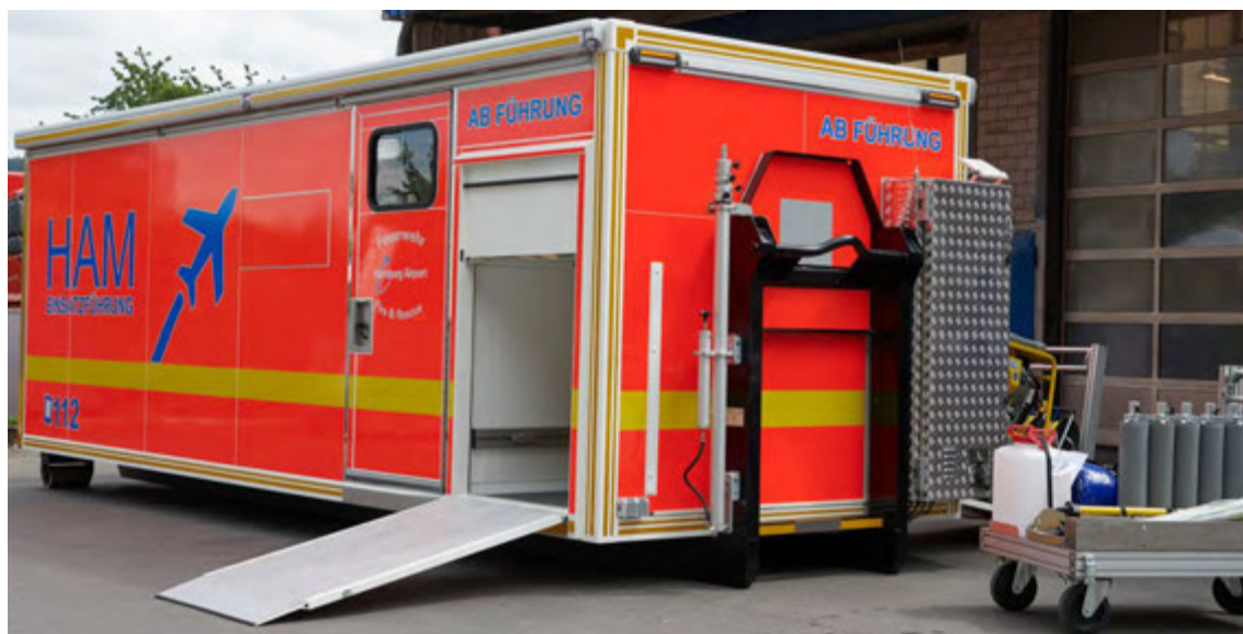
Abbildung 8: Geräteraumverschluss mit Rampe (hier länger als die Geräteraumhöhe ausgeführt, dadurch wird eine geringere Auffahrsschräge erreicht).
