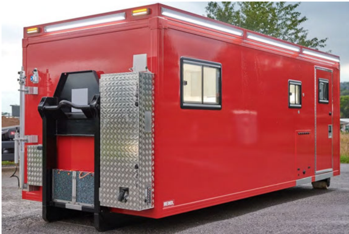
Abbildung 14: AB Mobile Wache mit Lichtmast und kompletter Umfeldbeleuchtung ringsherum.
