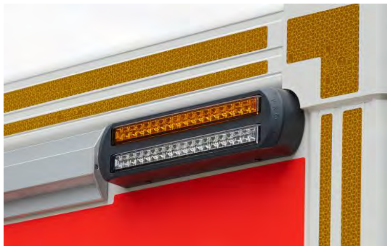
Abbildung 30: Die Positions- und Blinkleuchten sind separat schaltbar.
