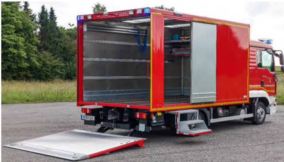
Abbildung 1: GW-L1 Ausführung Kofferaufbau (hier Aluminium-Bauweise).
