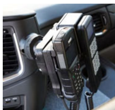
Abbildung 57: Montagebeispiel spezifische Halterung.
