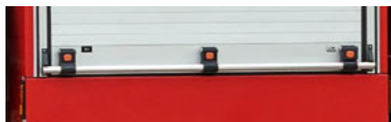
Abbildung 28: Geräteraumverschluss als durchgehende Griffstange, abschließbar.
