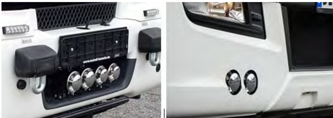
Abbildung 51: MARTIN-HORN®-Schallbecher in der Frontstoßstange integriert. Unterschiedliche Anordnungen je nach Fahrzeugtyp.
