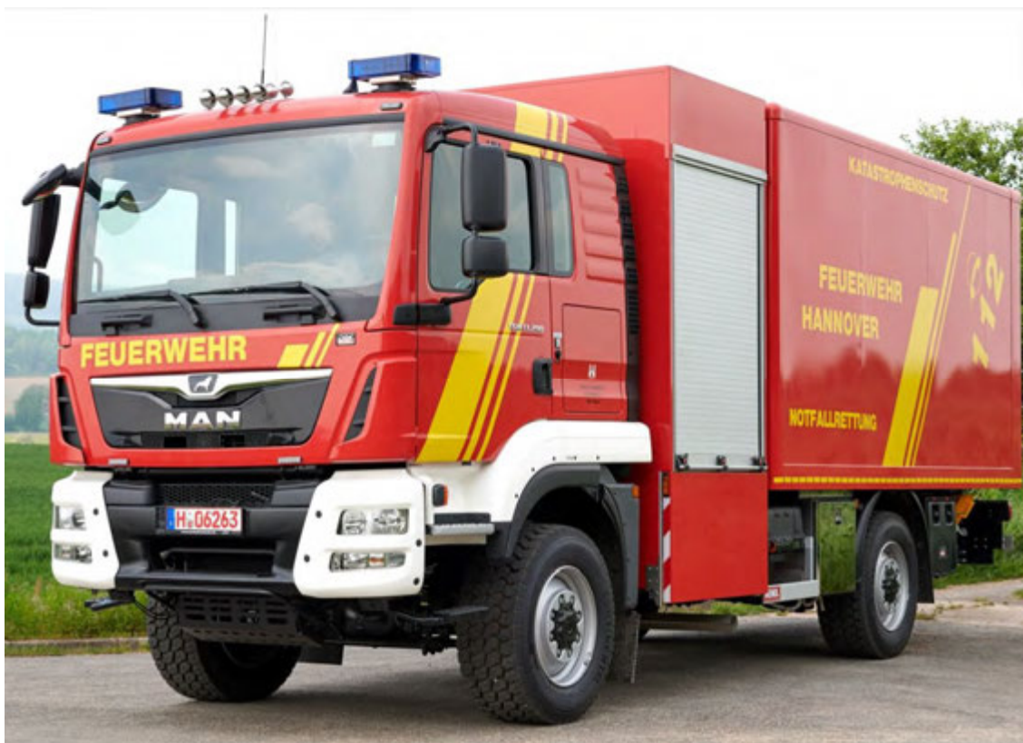
Abbildung 7: GW-L2 Ausführung Kofferaufbau (hier Aluminium-Bauweise), tiefgezogener separater Geräteraum für höchste Geländetauglichkeit.
