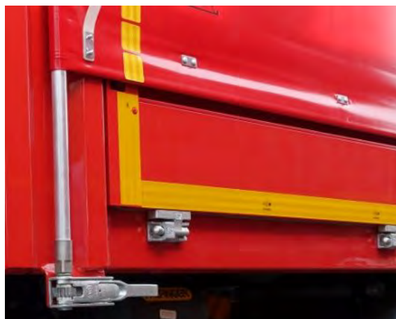
Abbildung 24: Spannvorrichtung der Seitenplane.
