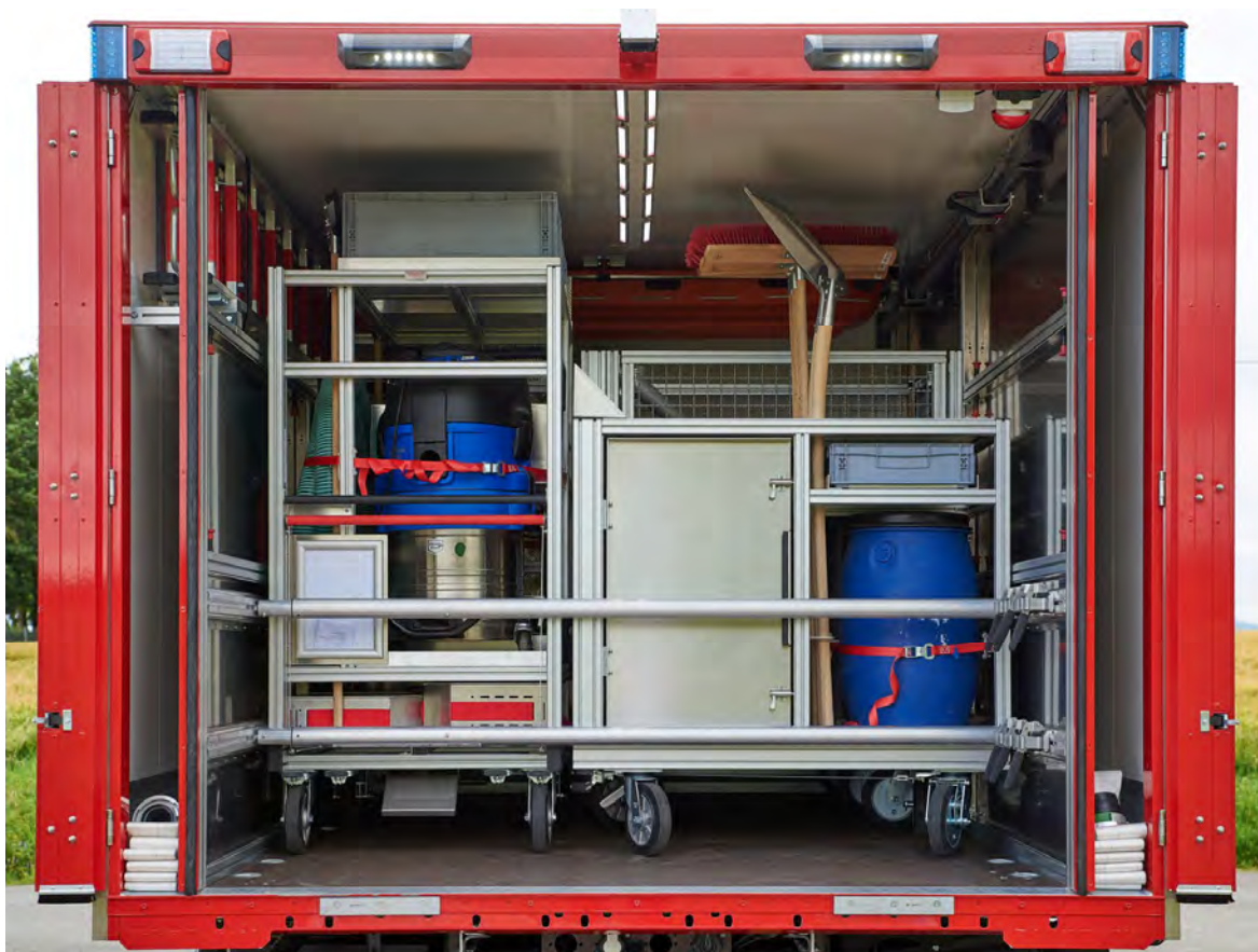
Abbildung 78: Schlauchdepot links und rechts je in einer doppelten Außenwand mit je einer separaten Hecktür.
