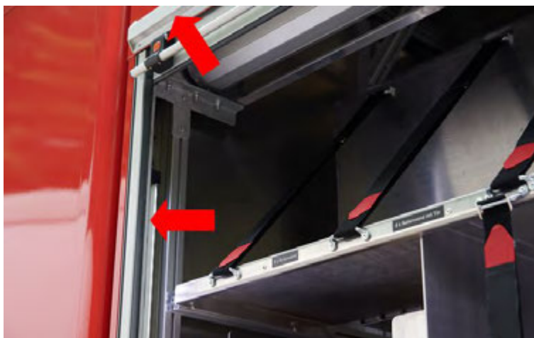
Abbildung 30: Geräte-raumbeleuchtung, LED-Langfeldleuchten innen und außen (Fabr. LDR).
