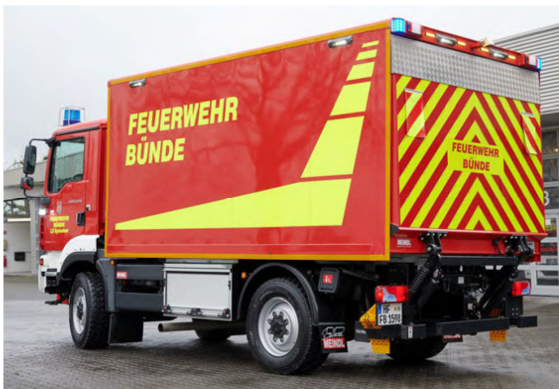
Abbildung 4: GW-L2 Sonderausführung Kofferaufbau (hier Aluminium-Bauweise) mit feststehender Heckkonsole.
