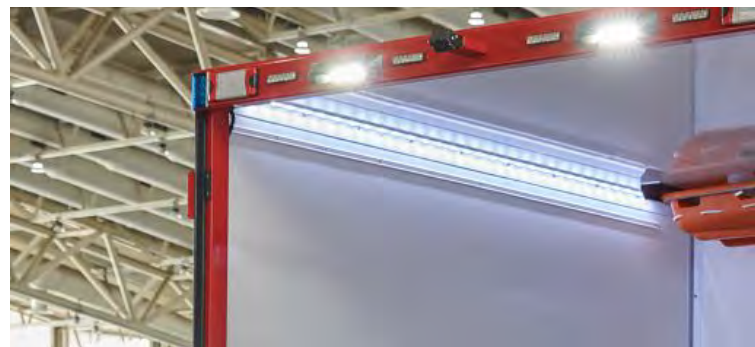
Abbildung 65: LED-Laderaumbeleuchtung (hier bei Ausführung Kofferaufbau).
