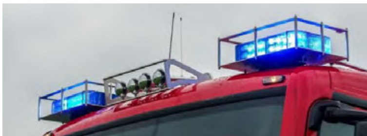
Abbildung 45: Astschutz, Edelstahl für Hänsch DBS 975.
