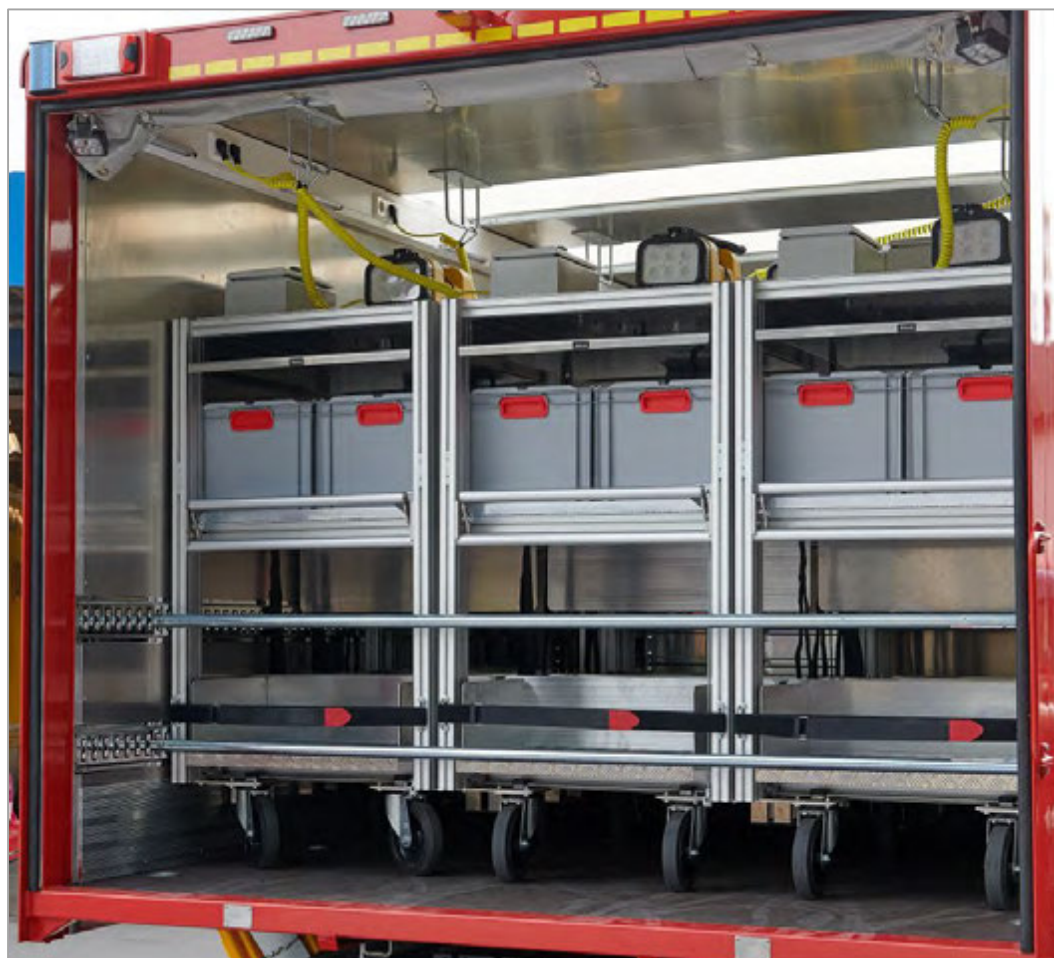
Abbildung 17: Detail – Laderaumbestückung, 230-V-Ladeanlage für in den Rollcontainern verlastete Geräte.
