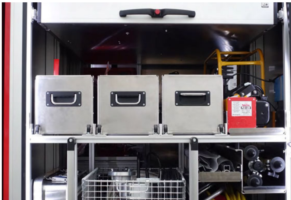
Abbildung 13: Detail – Facheinteilung, rollengelagerte Entnahmekästen mit Ausfallsicherung.
