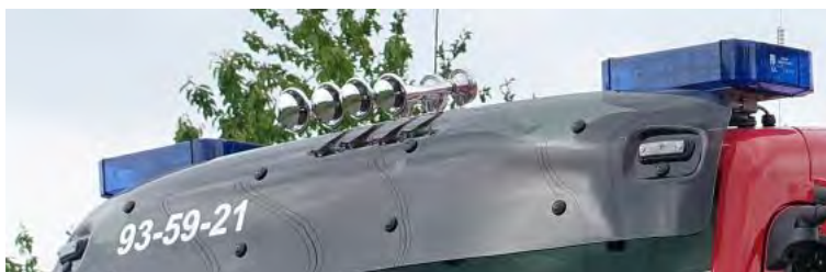
Abbildung 43: Geteilter Warnbalken, Hänsch DBS 975 LED mit Zusatz-Blitzern.
