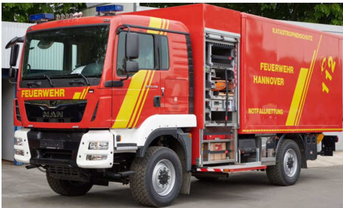
Abbildung 8: GW-L2 Ausführung Kofferaufbau, Rollladen-Geräteraum geöffnet und Auftrittsfläche abgeklappt.
