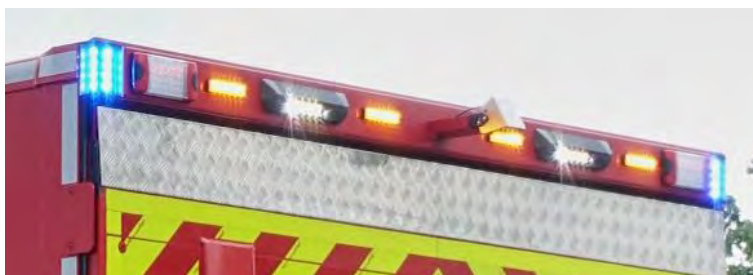
Abbildung 48: Feststehende Heckkonsole – Ladebordwand geschlossen.
