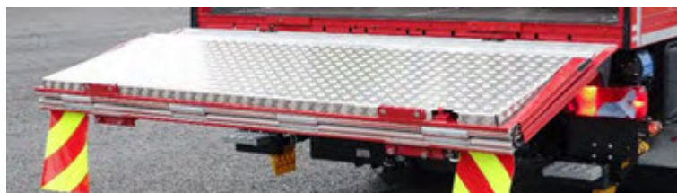
Abbildung 32: Plattform geteilt, hier mit optionalem Verschleißschutz.
