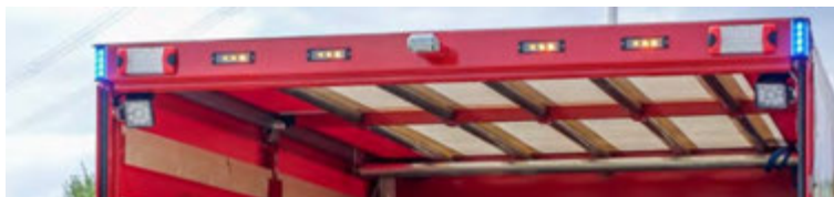
Abbildung 47: Feststehende Heckkonsole – Ladebordwand geöffnet.
