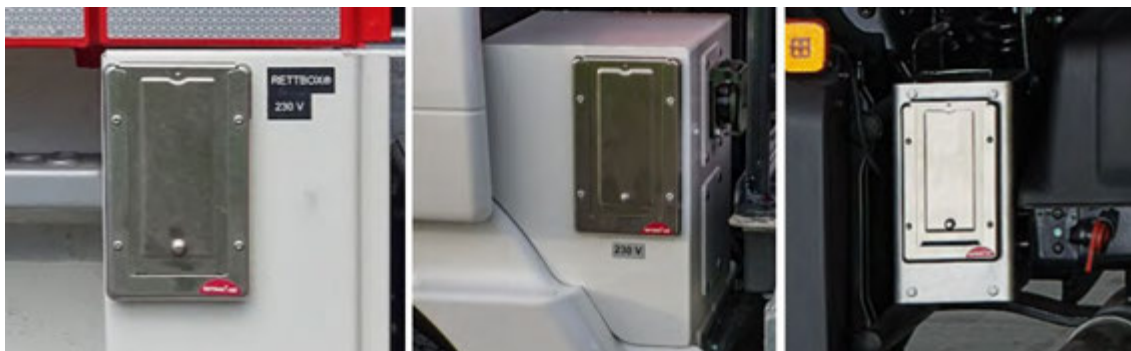
Abbildung 52: Beispiele verschiedener fahrzeugspezifischer MEINDL-Halterungen.
