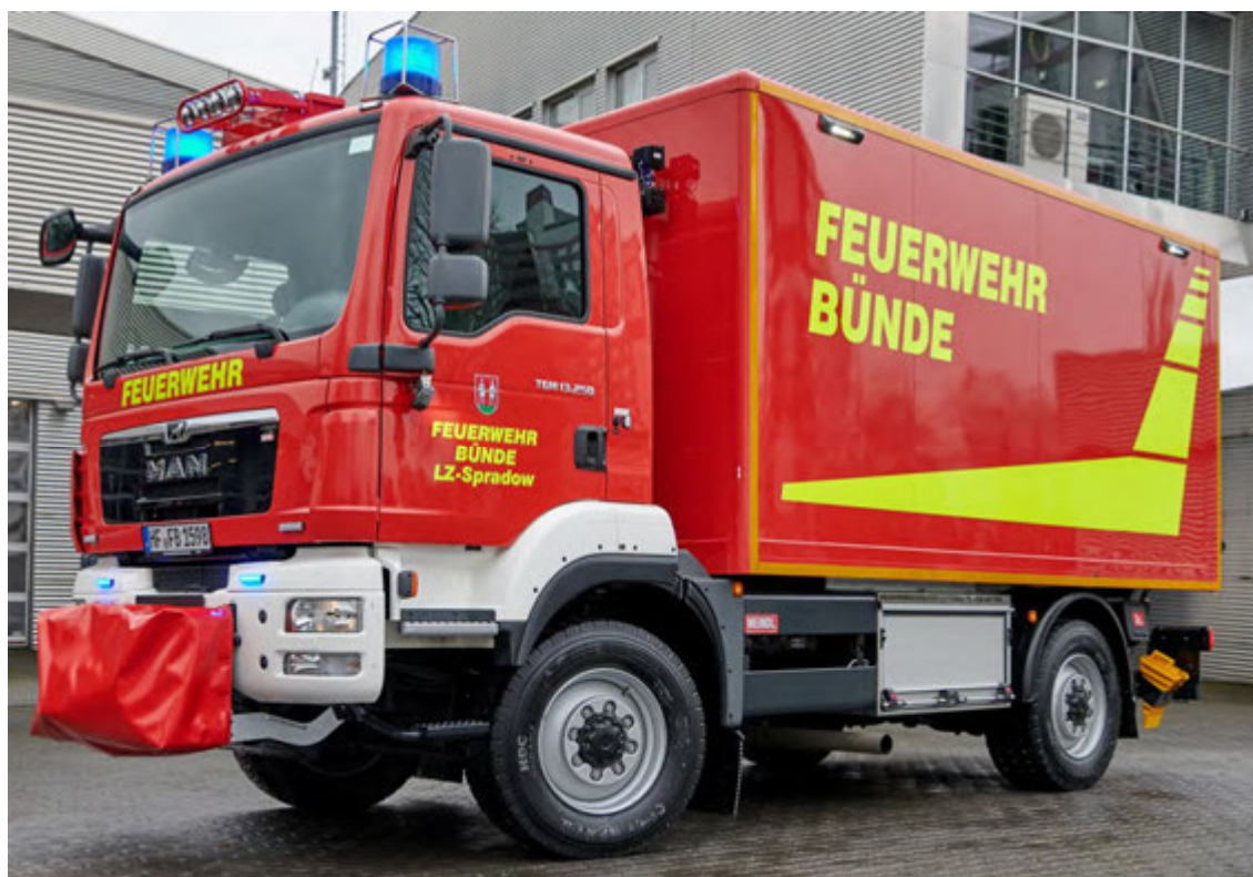
Abbildung 3: GW-L2 Sonderausführung Kofferaufbau (hier Aluminium-Bauweise).
