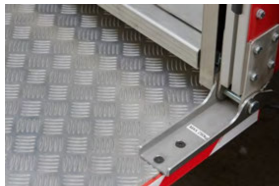
Abbildung 29: Zugangsklappe zum tiefgezogenen Geräteraum.
