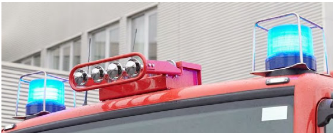
Abbildung 50: MARTIN-HORN® 2298 GM-Anlage auf dem Fahrzeugdach montiert. Kompressor im MEINDL-Dachkasten integriert.
