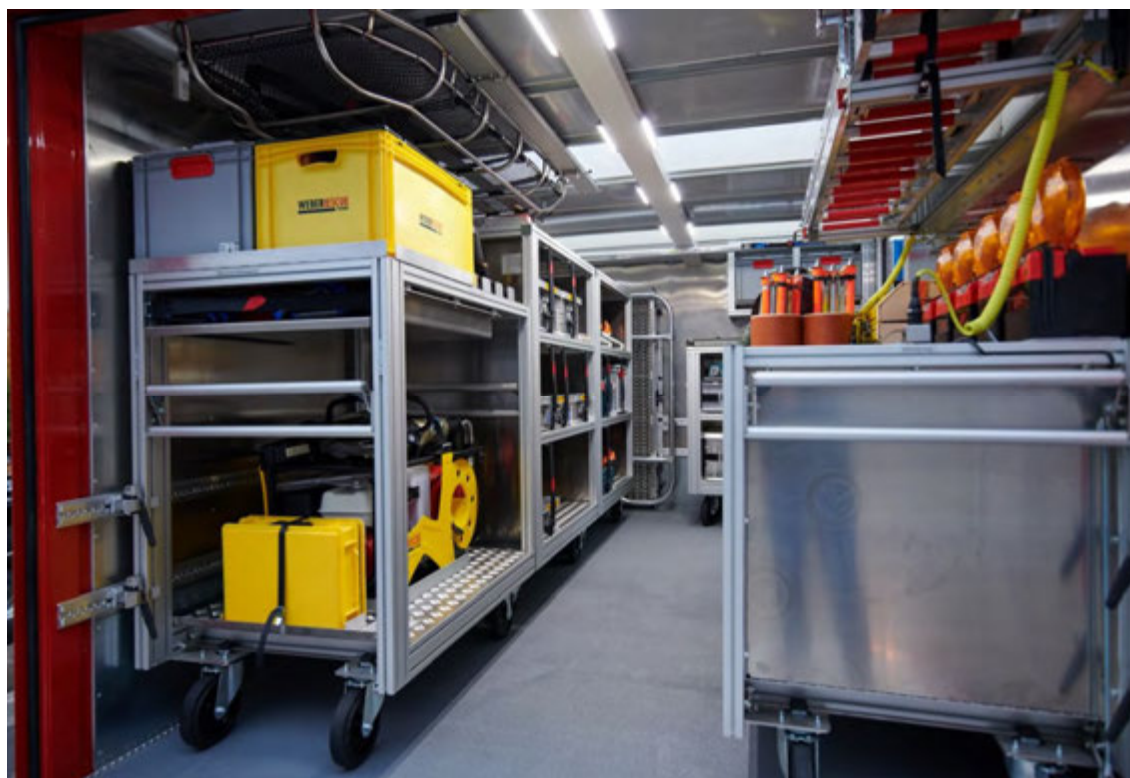
Abbildung 15: Detail – Laderaumbestückung mit MEINDL-Rollcontainern.
