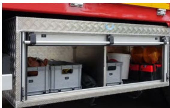
Abbildung 71: Staukasten – Edelstahl mit Alu-Rollladen.
