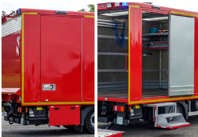
Abbildung 60: Seitentür hinten rechts (hier bei Kofferaufbau).
