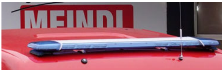
Abbildung 44: Warnbalken Hänsch DBS 5000 LED in besonders niedriger Bauhöhe.
