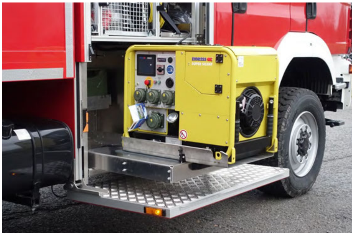
Abbildung 12: Detail – Generator auf MEINDL-Schwerlast-Schwenk-Auszug, Auftritt mit integrierten Warnleuchten.
