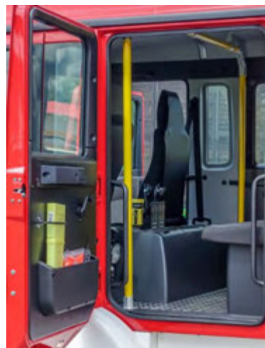
Abbildung 73: Ausbau Mannschaftsraum – Griffstangen.
