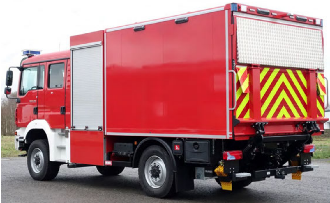
Abbildung 6: GW-L2 Ausführung Kofferaufbau, Ladebordwand horizontal geteilt, zum Verlegen von Schläuchen geeignet.
