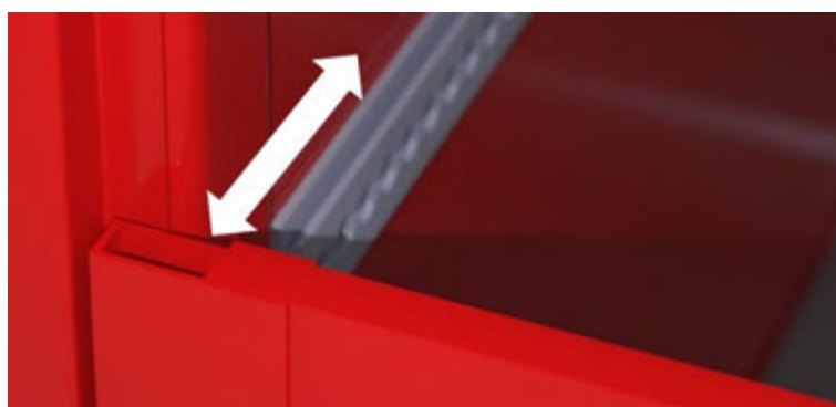
Abbildung 22: Bündige Stirnwand – ohne in die Ladefläche hineinragende Stirnrungen für optimale Be- und Entladung, z.B. mit einem Gabelstapler.
