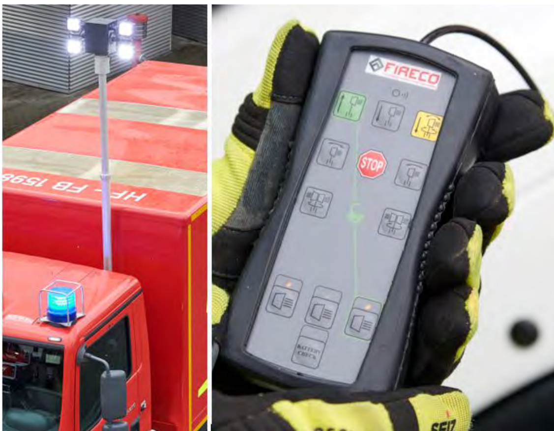
Abbildung 68: Lichtmast mit Fernsteuerung für alle Funktionen.
