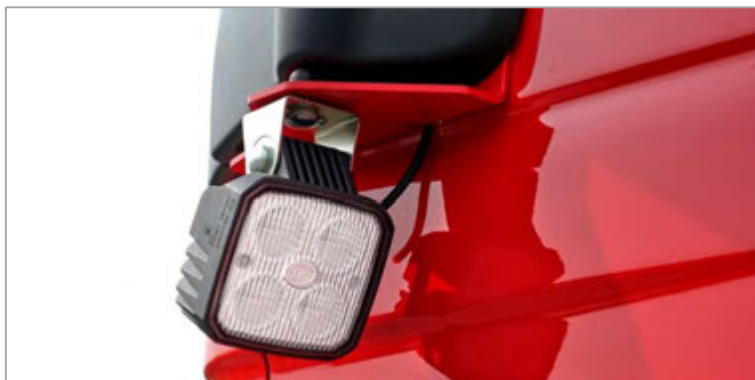
Abbildung 62: LED-Manövrierscheinwerfer an den Außenspiegelhalterungen.
