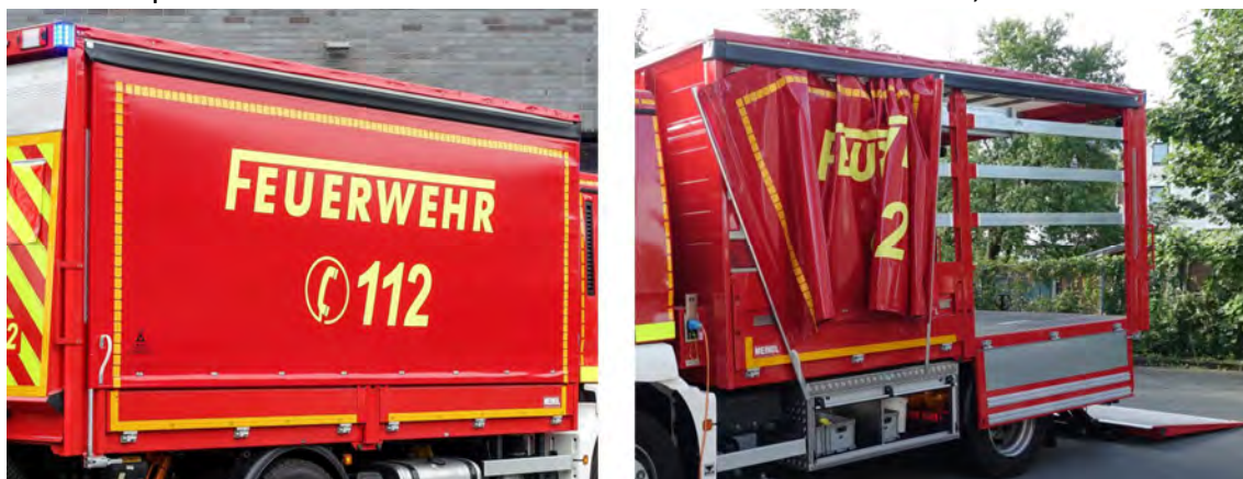
Abbildung 23: Seitenschiebepane geschlossen / geöffnet.
