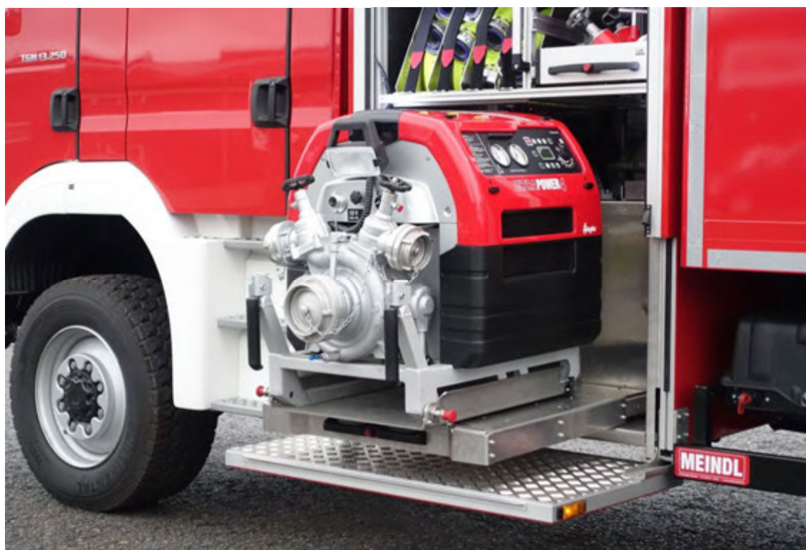
Abbildung 11: Detail – Tragkraftspritze auf MEINDL-Schwerlast-Schwenk-Auszug, „unsichtbar“ angeordnete Gasdruckfedern der seitlichen Zugangsklappen.
