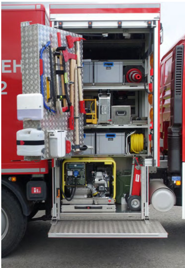
Abbildung 31: Schwenkwand mit MEINDL-Komfort-Verriegelung.
