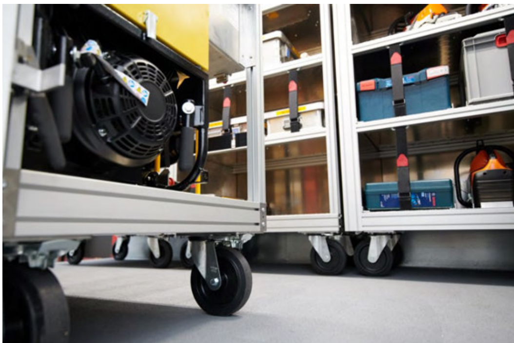
Abbildung 16: Detail – Ladeflächenboden kunststoffbeschichtet mit eingearbeitetem Granulat für höchste Rutschfestigkeit (>R11).
