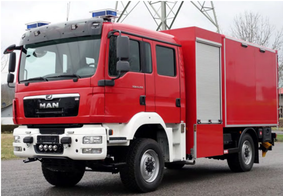
Abbildung 5: GW-L2 Ausführung Kofferaufbau (hier FerroFoam®-Bauweise), tiefgezogener separater Geräteraum für höchste Geländetauglichkeit.
