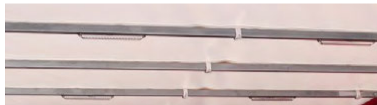
Abbildung 64: LED-Laderaumbeleuchtung (hier bei Ausführung Planendach).
