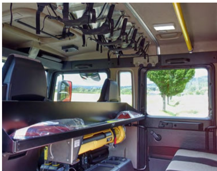
Abbildung 74: Ausbau – Mannschaftsraum: Helmhalter, Ablagen, Kleiderbügel.
