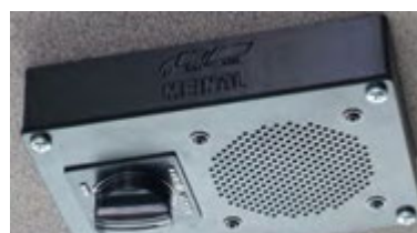
Abbildung 58: Funkzusatzlautsprecher im MEINDL-Montagerahmen.
