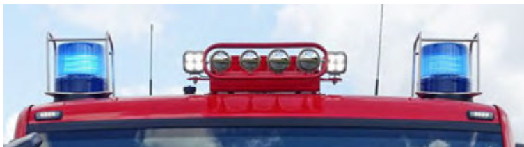
Abbildung 42: RKL rund, Hänsch NOVA-LED, hier mit optionalem Astschutz.
