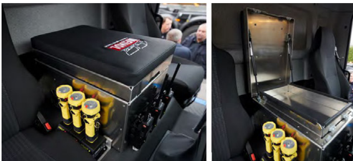
Abbildung 40: Konsolenkasten für Zentralelektrik (hier Alu natur), Oberdeckel in Kunstleder bezogen und gepolstert.
