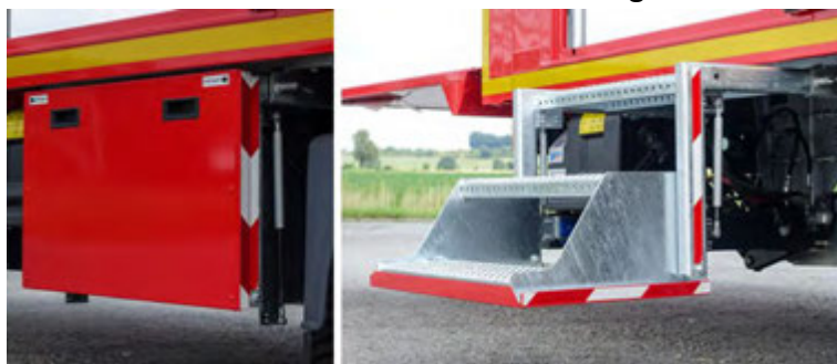
Abbildung 61: Schiebe-Klappritt für Aufbau-Zugang über die Seitentür.
