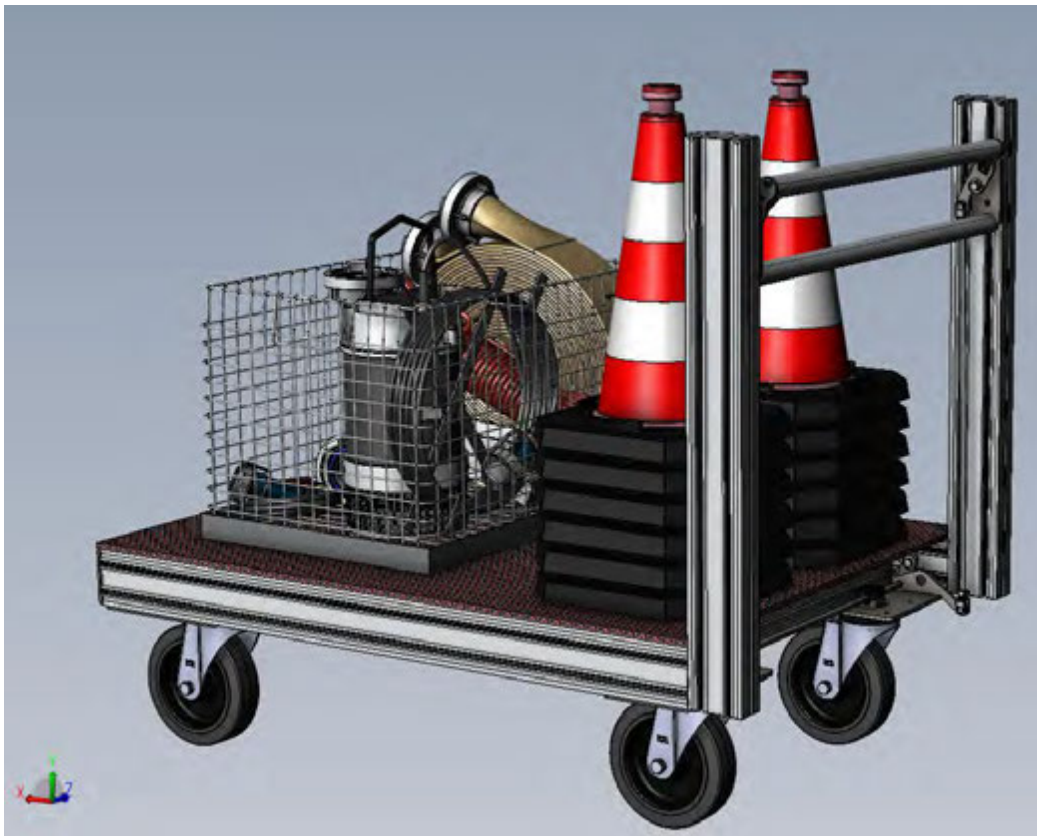
Abbildung 11: Detail – 3D-Konstruktionsansicht MEINDL-Rollcontainer „1x Plattform“ mit Beladung.
