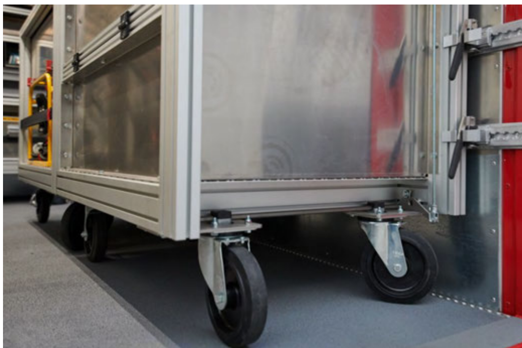
Abbildung 9: Detail – Nach innen versetzte vordere Lenkrollen, dadurch können sich die Lenkrollen beim Entnehmen der Rollcontainer nicht an der Seitenwand festfahren, Sicherung der Rollcontainer mit Kerl JF-Schnellspannern.
