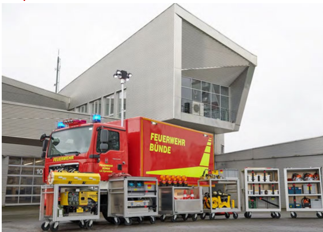
Abbildung 4: Im GW-L verlastete Rollcontainer – konstruiert nach Vorgabe mit Lagerung der Beladung. Die Anordnung der Beladung erfolgt vorab in 3D-Zeichnungen.
