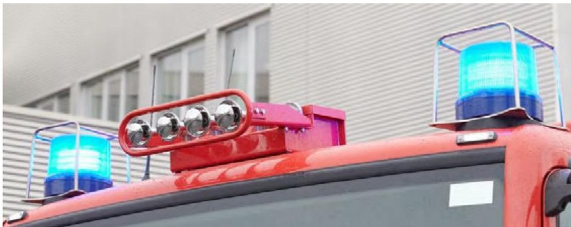
Abbildung 36: MARTIN-HORN® 2298 GM-Anlage auf dem Fahrzeugdach montiert. Kompressor im MEINDL-Dachkasten integriert.
