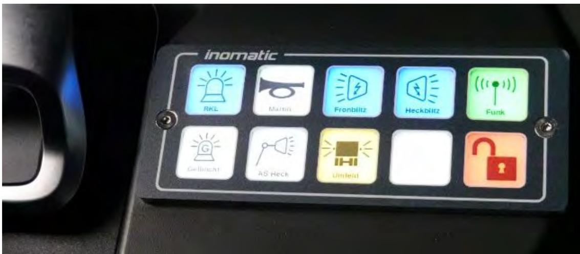
Abbildung 25: Options-Bedienteil WLF (hier im Armaturenbrett integriert montiert).
