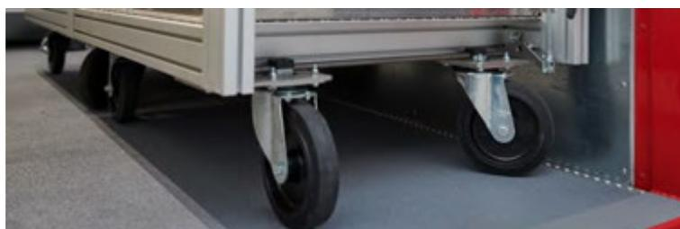
Abbildung 36: Ladeflächenboden kunststoffbeschichtet.
