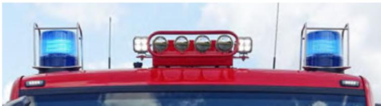
Abbildung 42: RKL rund, Hänsch NOVA-LED, hier mit optionalem Astschutz.
