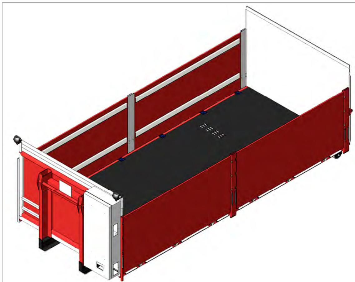
Abbildung 4: AB Transport als offener Pritschenaufbau. 3D-Entwurfszeichnung. Anhand der Entwurfszeichnung erfolgt in der Regel die Baubesprechung.
