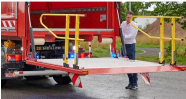
Abbildung 47: Absturzsicherung am Vertikallift, klappbar.
