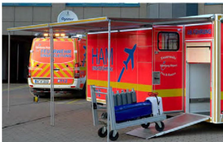
Abbildung 58: Seitlich montierte Markise mit Abstützung.
