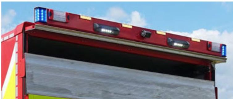
Abbildung 49: Klappbare Automatik-Konsole – geöffnet.
