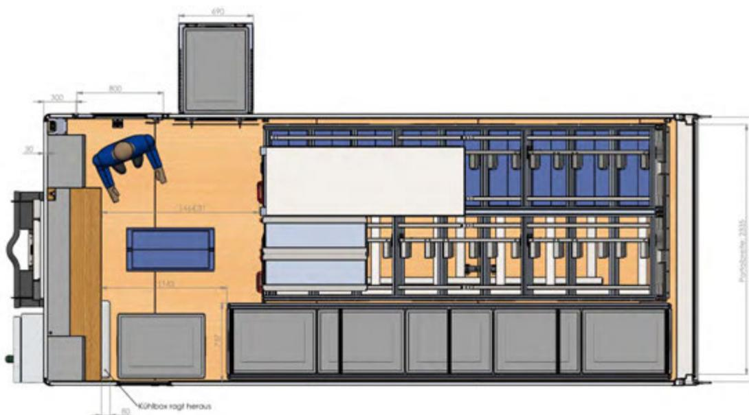
Abbildung 2: Schnittansicht, vorne der Arbeitsraum mit Übergabeklappe.
