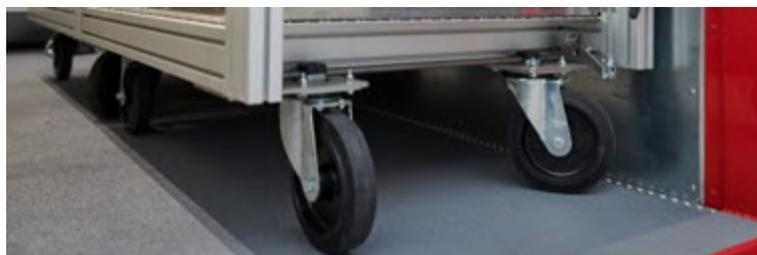
Abbildung 59: Ladeflächenboden kunststoffbeschichtet.
