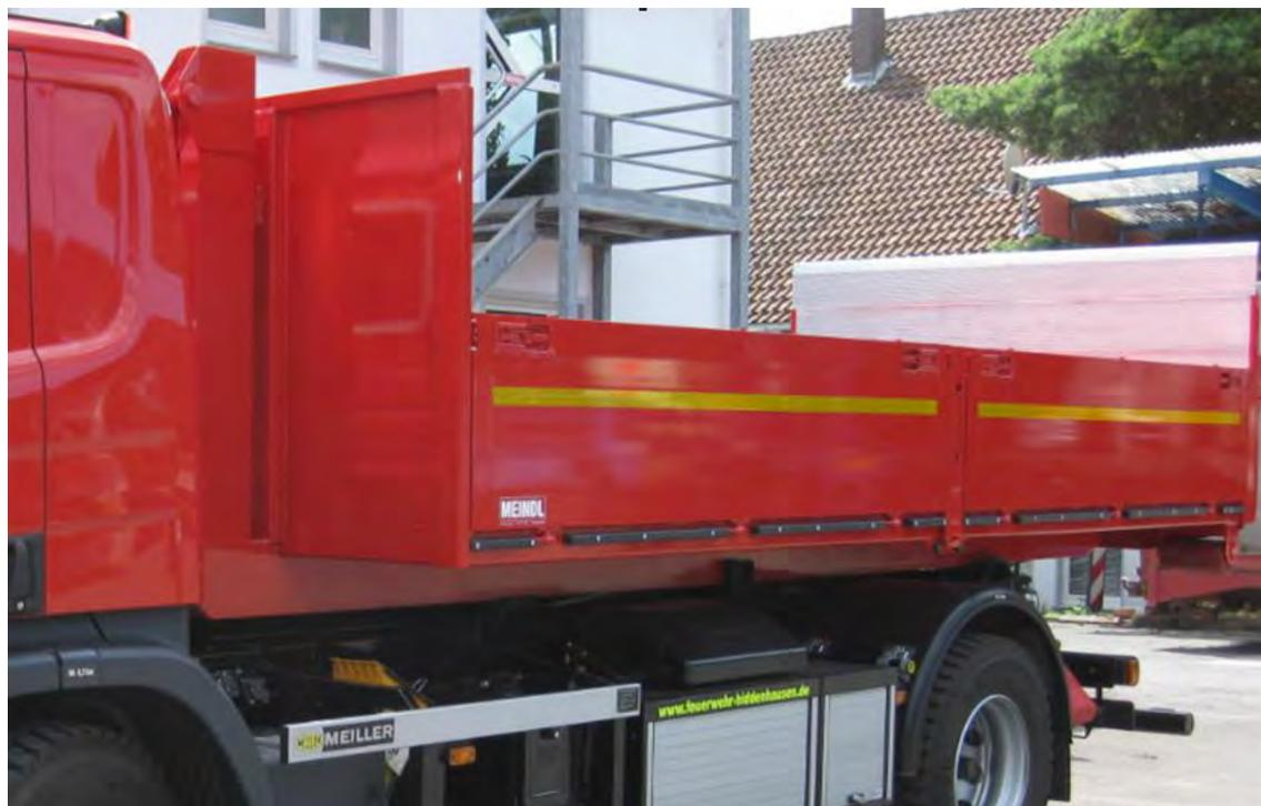
Abbildung 1: AB Transport als offener Pritschenaufbau.
