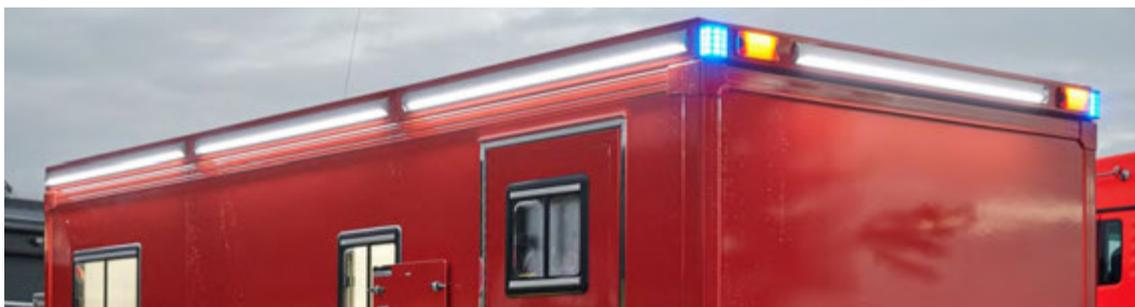
Abbildung 42: LED-Lichtstreifenelemente Fabr. LDR, seitlich und hinten.
