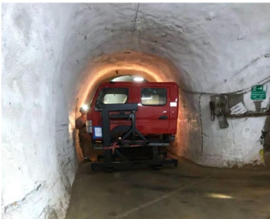
Abbildung 6: Transport des Segmentes „Fahrerhaus“ unter Tage.
