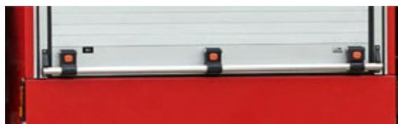
Abbildung 28: Geräteraumverschluss als durchgehende Griffstange, abschließbar.
