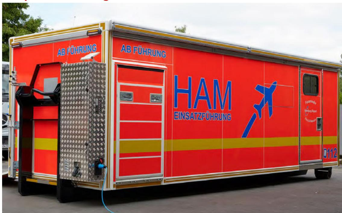
Abbildung 7: AB Führung mit vorderen abgetrennten Geräteräumen mit Rollladen, Kunststoff-Sandwichbauweise. LED-Umfeldbeleuchtung über die gesamte Aufbauhöhe sowie vorne und hinten über die gesamte Breite. Seitlich aufgesetzte Markise über die gesamte Außenlänge (die Grundbreite des Behälters muss dafür geringer sein, dadurch Verringerung der lichten Breite innen).
