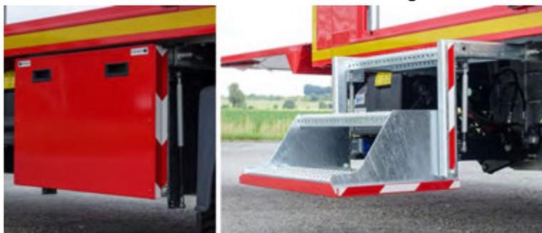
Abbildung 61: Schiebe-Klappritt für Aufbau-Zugang über die Seitentür.
