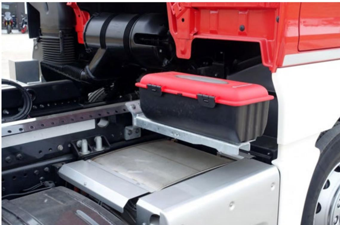
Abbildung 15: Detail – Verzinkte MEINDL-Schraub-Anbauhalterung (hier für Feuerlöscher). Ermöglicht flexible Positionierung.
