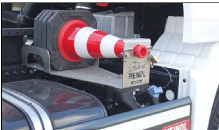
Abbildung 49: Leitkegelhalterung, flexibel am Fahrzeug positionierbar.
