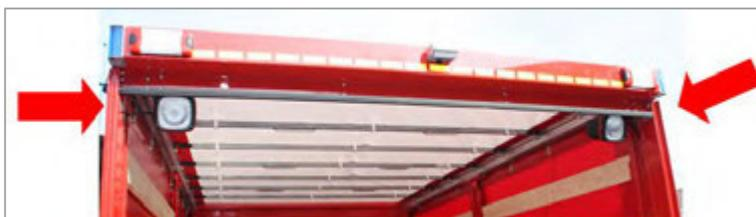
Abbildung 40: LED-Arbeitsstellenscheinwerfer im Heckportal, schwenkbar.
