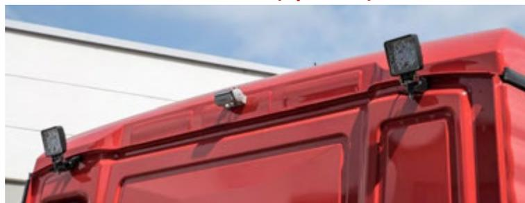
Abbildung 53: LED-Arbeitsstellenscheinwerfer hinten oben am Fahrerhaus.
