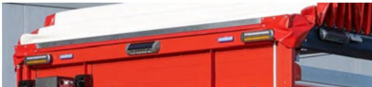
Abbildung 32: Frontblitzer (hier bei Planenausführung mit Schiebedachanlage).
