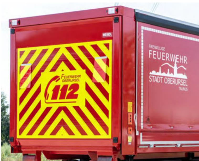
Abbildung 51: Heckschraffur-Kennzeichnung, seitliche Konturmarkierung, Beschriftung nach Vorgabe.
