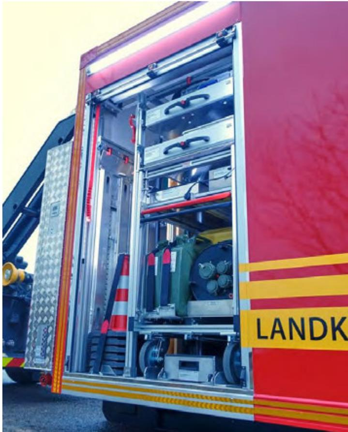
Abbildung 5: Detail – Vorderer separater Geräteraum mit Regalanlage.
