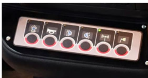
Abbildung 38: Standard-Bedienteil GW-L1.
