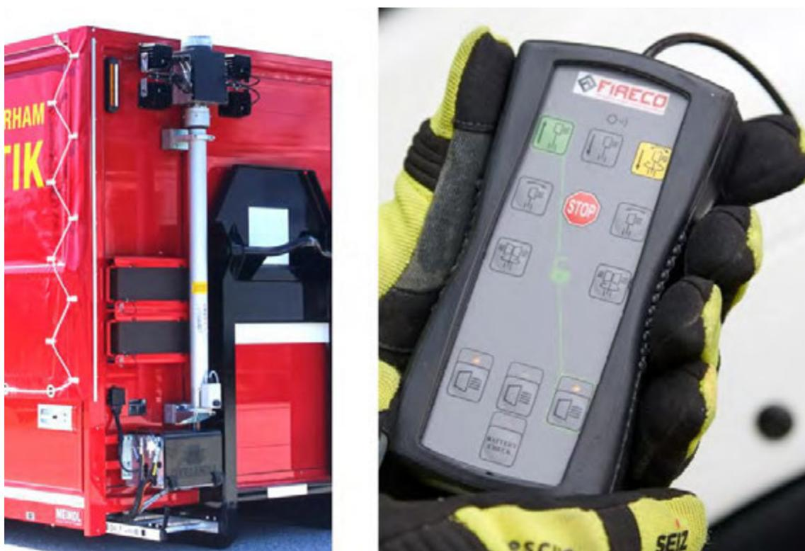
Abbildung 43: Lichtmast (hier zusätzlich mit LED-Blitzleuchte, grün). Ausführung mit Elektro-Druckluftheizer. Fernsteuerung für den Lichtmast.
