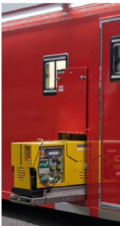
Abbildung 21: Detail – Silent-Stromerzeuger auf MEINDL-Schwerlastauszug. Alternativ kann der Stromerzeuger auf einem Rollcontainer verlastet werden. Durch eine Verbindungsleitung zum AB führt diese Lösung im Innenraum zu einer deutlichen Geräuschminderung.
