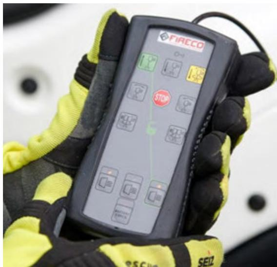
Abbildung 55: Fernbedienung für alle Lichtmastfunktionen.
