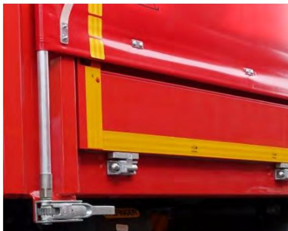
Abbildung 24: Spannvorrichtung der Seitenplane.
