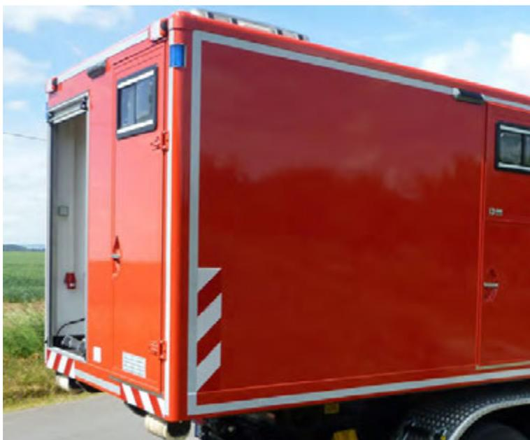
Abbildung 61: Kontur- und DIN-Warnmarkierung.
