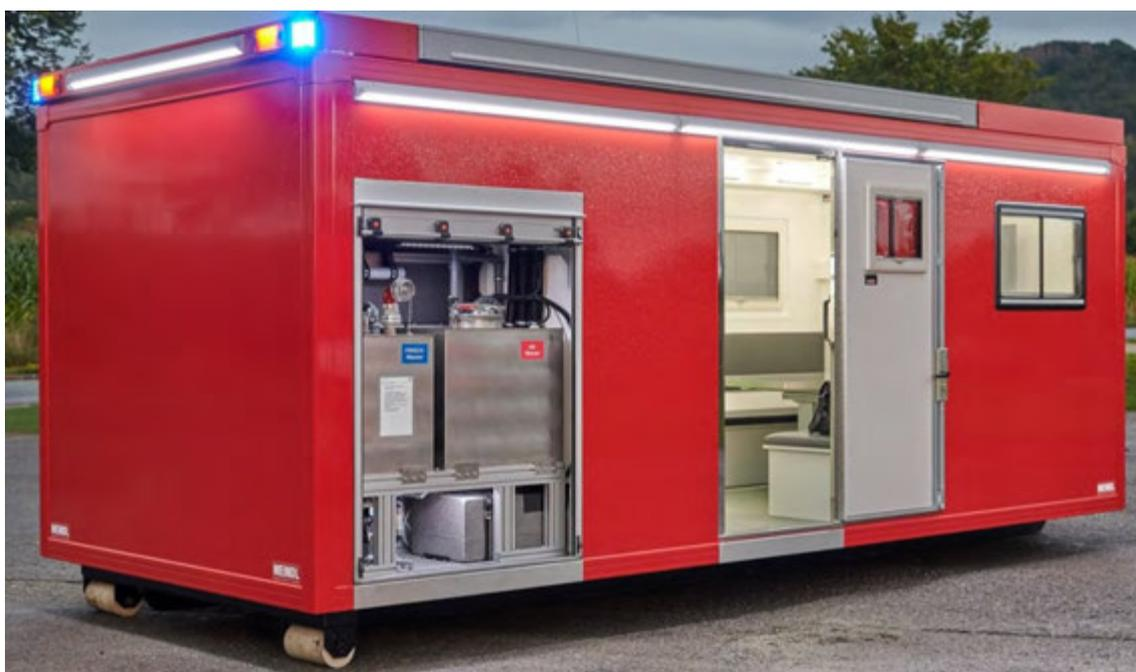
Abbildung 15: AB Mobile Wache mit Hauswasserwerk, Seitentür und bündig in der Dachgalerie eingelassener Dachmarkise.
