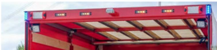
Abbildung 47: Feststehende Heckkonsole – Ladebordwand geöffnet.
