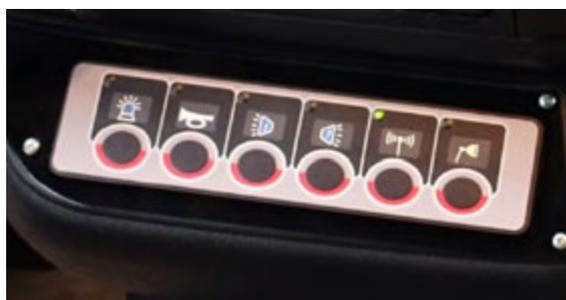
Abbildung 24: Standard-Bedienteil WLF (hier im Armaturenbrett integriert montiert).
