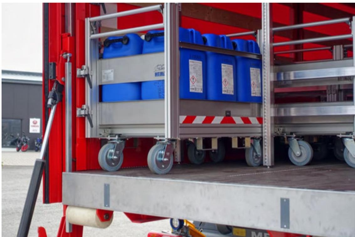
Abbildung 12: Detail – Glatter Edelstahl-Bodenabschluss, Heckportal, Kunststoff-Ablaufrollen.
