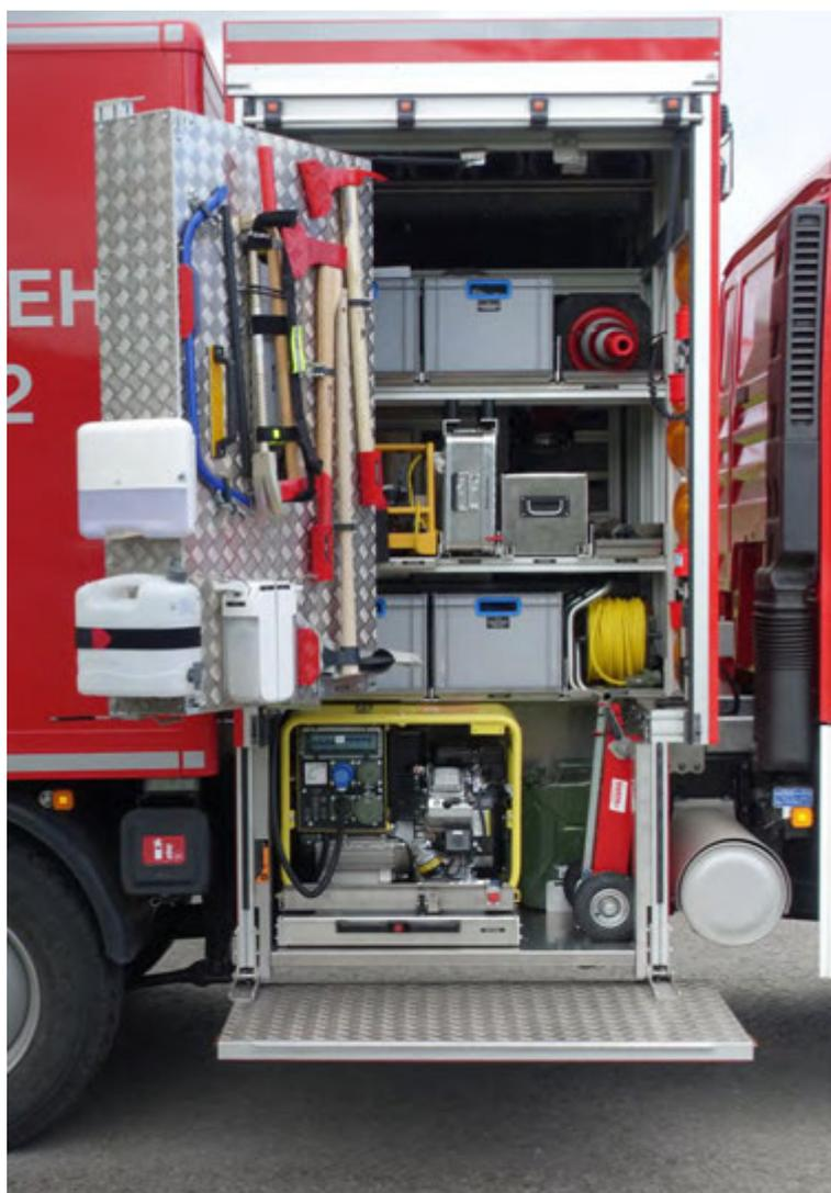
Abbildung 31: Schwenkwand mit MEINDL-Komfort-Verriegelung.
