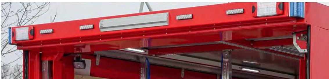
Abbildung 45: LED-Lichtstreifenelement Fabr. LDR, hinten.
