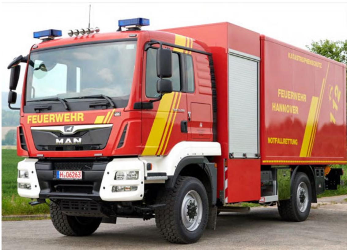
Abbildung 7: GW-L2 Ausführung Kofferaufbau (hier Aluminium-Bauweise), tiefgezogener separater Geräteraum für höchste Geländetauglichkeit.
