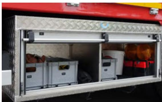
Abbildung 71: Staukasten – Edelstahl mit Alu-Rollladen.
