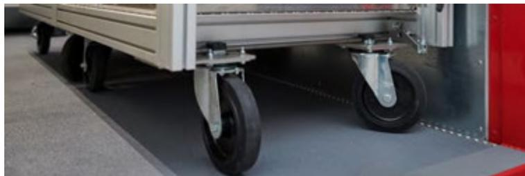
Abbildung 36: Ladeflächenboden kunststoffbeschichtet.
