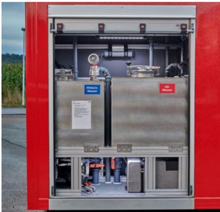
Abbildung 55: MEINDL-Edelstahl-Hauswasseranlage in separatem, abgeschottetem Hauswasserraum mit Zugang über seitlich montierten Rollladen.
