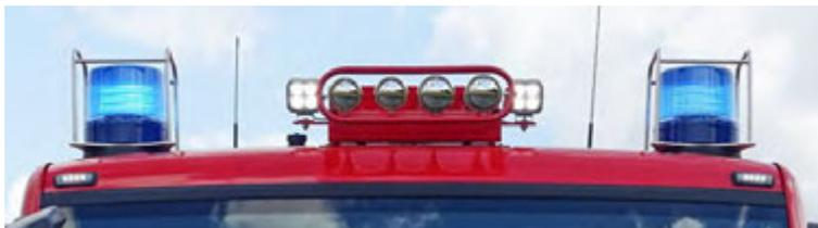
Abbildung 28: RKL rund, Hänsch NOVA-LED, hier mit optionalem Astschutz.
