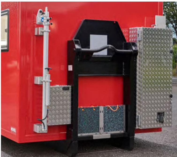
Abbildung 35: Entkoppelter Aufnahmebügel mit großflächigem Anstoßschutz.
