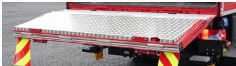
Abbildung 32: Plattform geteilt, hier mit optionalem Verschleißschutz.
