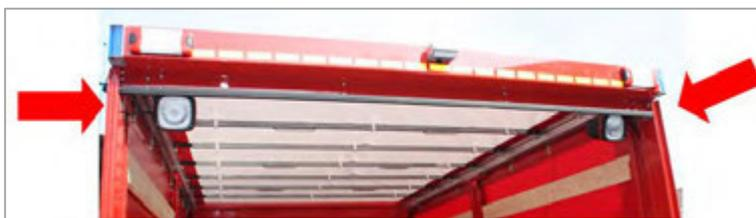
Abbildung 63: LED-Arbeitsstellenscheinwerfer im Heckportal, schwenkbar.
