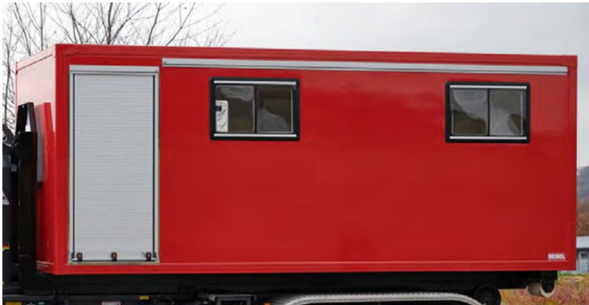
Abbildung 1: AB Besprechung mit vorderen abgetrennten Geräteräumen mit Rollladen, Kunststoff-Sandwichbauweise. LED-Umfeldbeleuchtung über die gesamte Aufbauhöhe.
