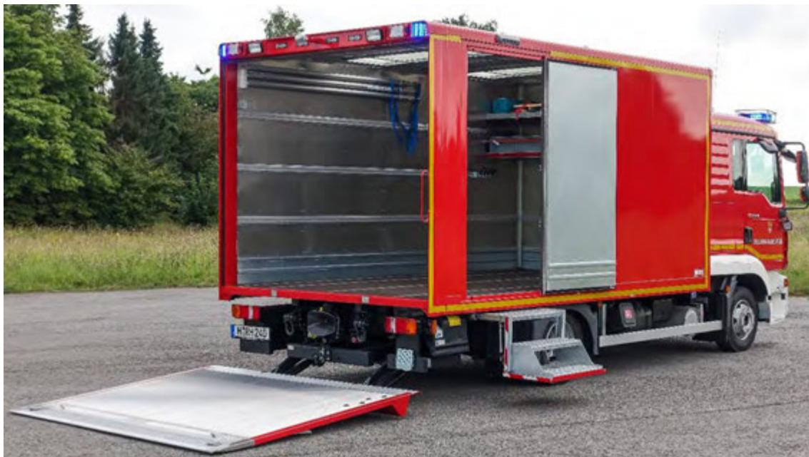
Abbildung 1: GW-L1 Ausführung Kofferaufbau (hier Aluminium-Bauweise).
