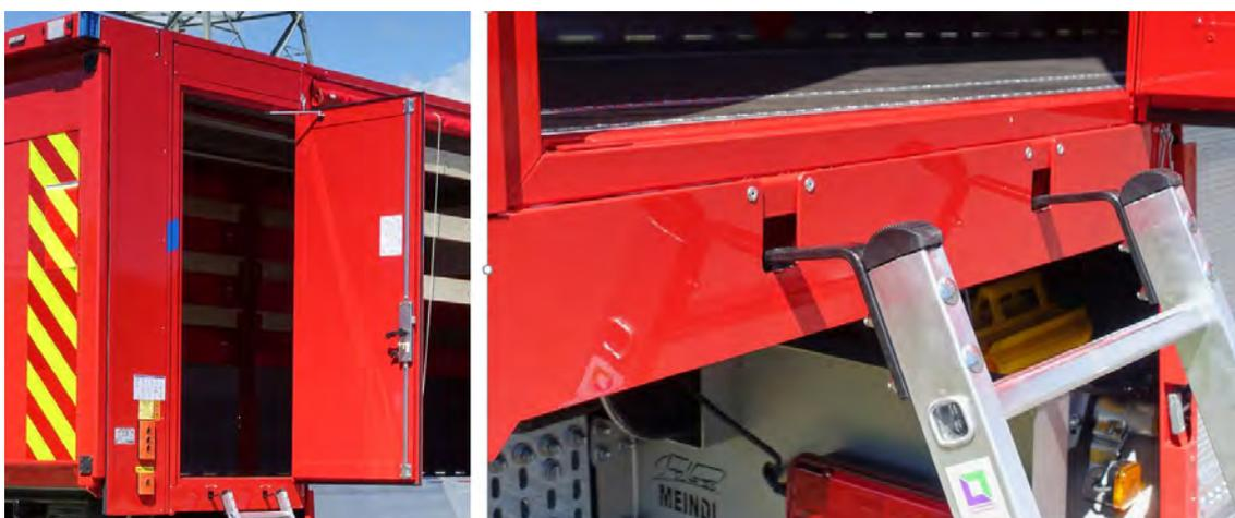
Abbildung 37: Seitentür hinten rechts, einhängbare Auftrittleiter.
