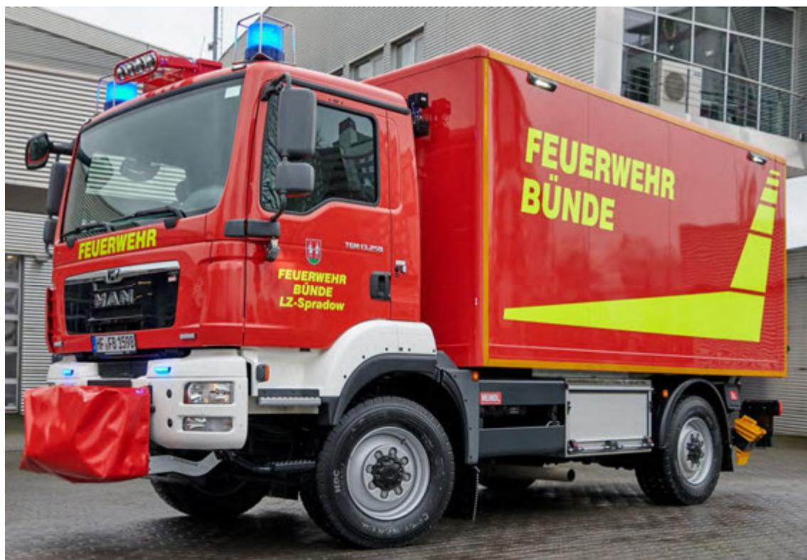
Abbildung 3: GW-L2 Sonderausführung Kofferaufbau (hier Aluminium-Bauweise).
