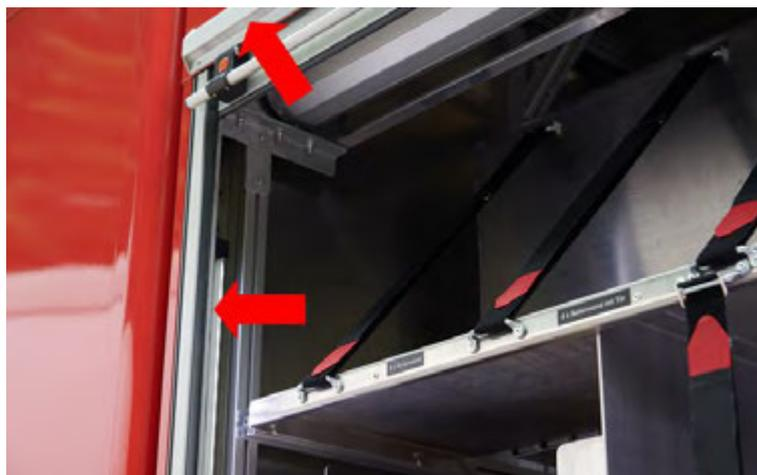
Abbildung 30: Geräte-raumbeleuchtung, LED-Langfeldleuchten innen und außen (Fabr. LDR).
