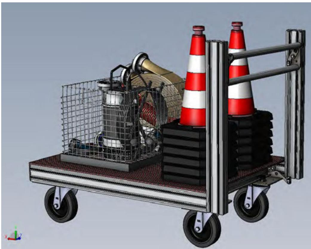
Abbildung 11: Detail – 3D-Konstruktionsansicht MEINDL-Rollcontainer „1x Plattform“ mit Beladung.
