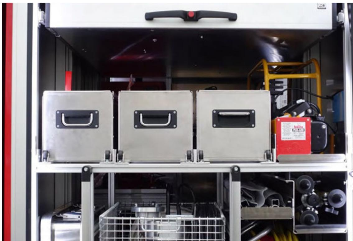
Abbildung 13: Detail – Facheinteilung, rollengelagerte Entnahmekästen mit Ausfallsicherung.
