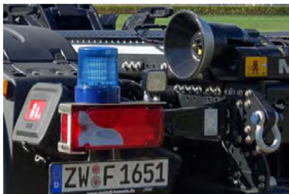
Abbildung 35: Heck-Rundumkennleuchte auf MEINDL-Edelstahlhalterung.
