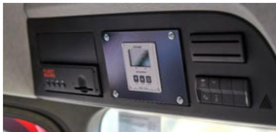
*Abbildung 61: Ladezustandsanzeige, hier im Fahrerhaus oberhalb der Windschutzscheibe integriert.*
