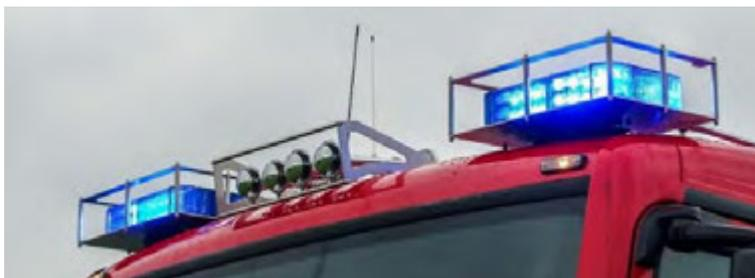
Abbildung 45: Astschutz, Edelstahl für Hänsch DBS 975.
