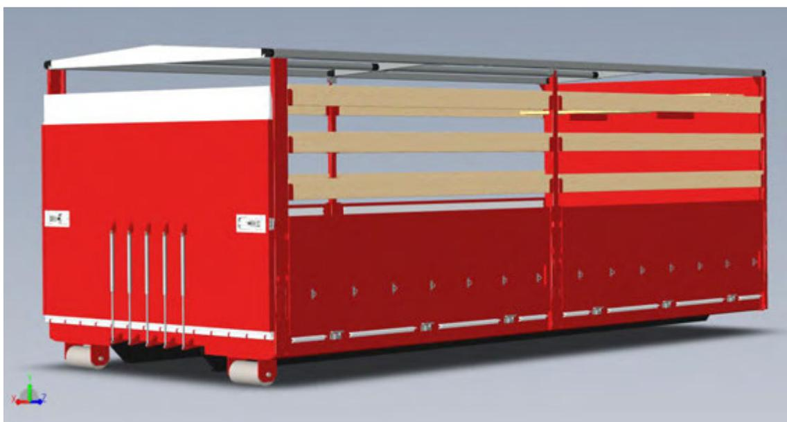
Abbildung 6: AB Transport als geschlossener Pritschenaufbau. 3D-Entwurfszeichnung.
