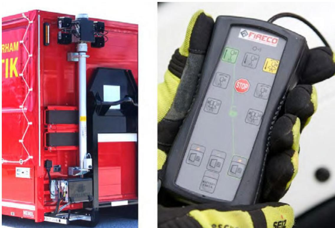
Abbildung 46: Lichtmast (hier zusätzlich mit LED-Blitzleuchte, grün). Ausführung mit Elektro-Druckluftherzeuger. Fernsteuerung für den Lichtmast.
