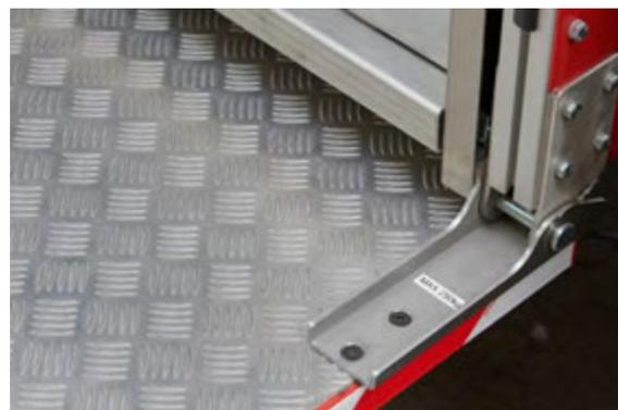
Abbildung 29: Zugangsklappe zum tiefgezogenen Geräteraum.
