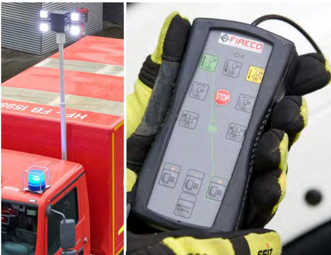
Abbildung 68: Lichtmast mit Fernsteuerung für alle Funktionen.
