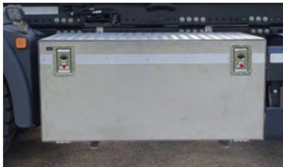
Abbildung 57: Staukasten – Edelstahl mit Klappe.
