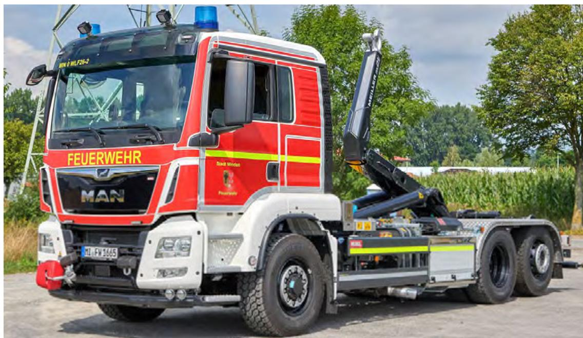
Abbildung 2: WLF 26/6900 auf MAN TGS-Fahrgestell mit HydroDrive (1. Achse hydraulisch angetrieben) und maschineller Zugeinrichtung Rotzler TR 030 FIRE ( $\geq 50$  KN Nennzugkraft).
