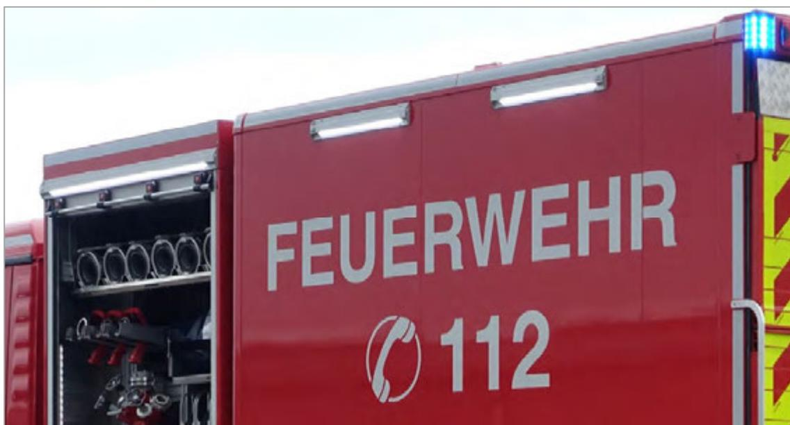
Abbildung 67: LED-Lichtstreifenelemente Fabr. LDR, seitlich.
