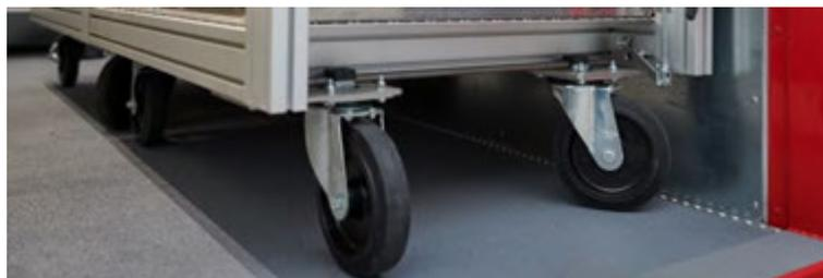
Abbildung 37: Ladeflächenboden kunststoffbeschichtet.
