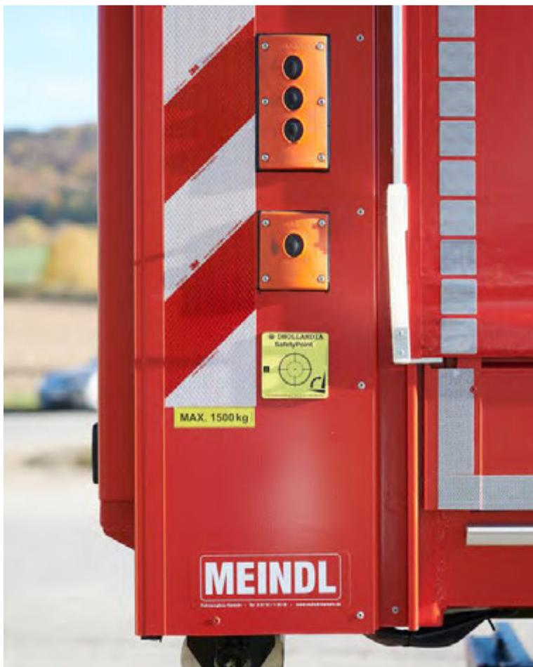
Abbildung 16: Detail – Hand-Bedienung des Vertikallifts hinten im Heckportal (Serie).
