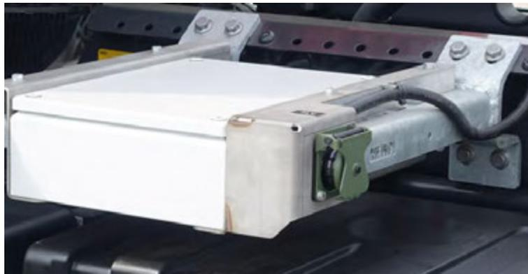
Abbildung 22: Zentralelektrik – Standard: Anordnung seitlich am Fahrgestellrahmen an verzinkten Halterungen und entsprechenden Edelstahlauflagen, kombiniert mit der Stromversorgung für den AB nach VG 96923-3, DIN 14505.
