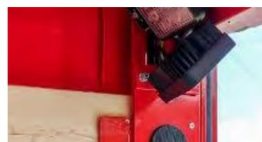
Abbildung 79: Mikrofon und Taster im Laderaum.
