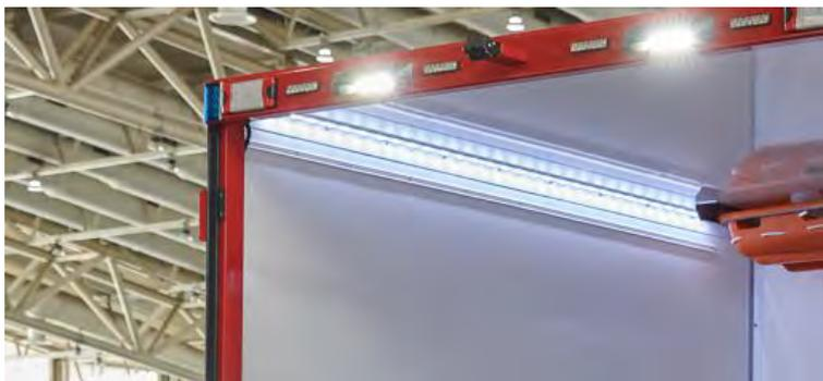
Abbildung 42: LED-Laderaumbeleuchtung (hier bei Ausführung Kofferaufbau).
