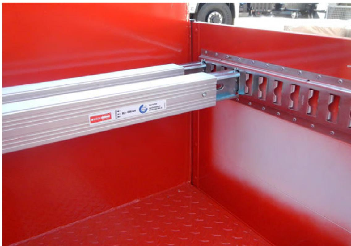
Abbildung 14: Detail – Alternative Ladungssicherung mit Sperrbalken.
