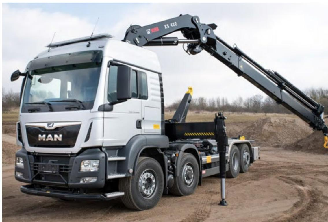
Abbildung 6: WLF 32/6900 auf MAN TGS 8x4H-6-Fahrgestell (2. Achse hydraulisch angetrieben, 1., 2. und 4. Achse gelenkt), 42 m Ladekran, Wechsellader-Anlage in Schiebe-Knick-Ausführung zur niedrigen Behälteraufnahme in Tiefgaragen (Polizei).
