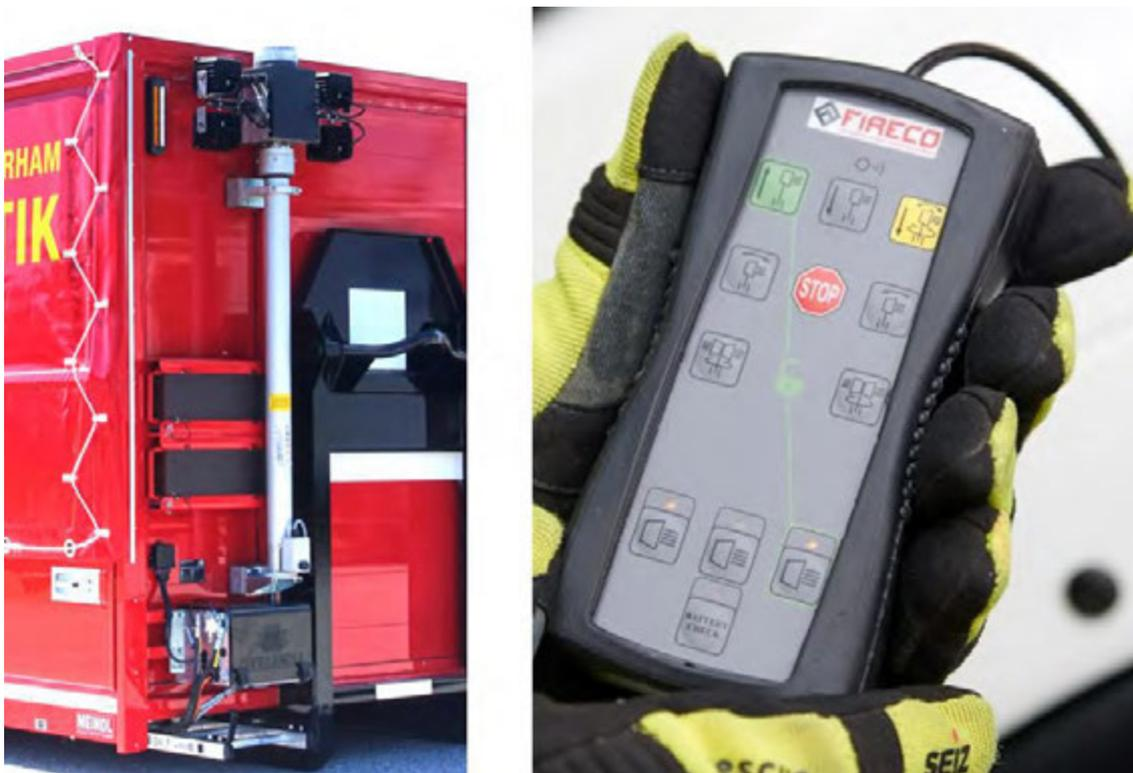
Abbildung 45: Lichtmast (hier zusätzlich mit LED-Blitzleuchte, grün). Ausführung mit Elektro-Drucklufizerzeuger. Fernsteuerung für den Lichtmast.
