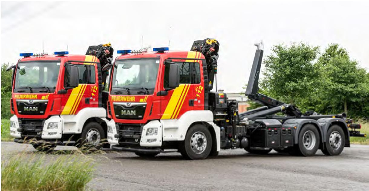
Abbildung 3: WLF 26/6400 auf MAN TGS-Fahrgestell mit HIAB 18 tm-Ladekran.
