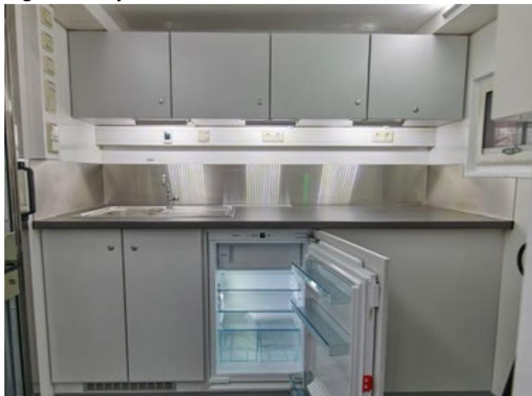
Abbildung 57: Küchenzeile mit Waschbecken, Kühlschrank. Hier rechts vom Kühlschrank das (von außen zugängliche) Fach für den Stromerzeuger.
