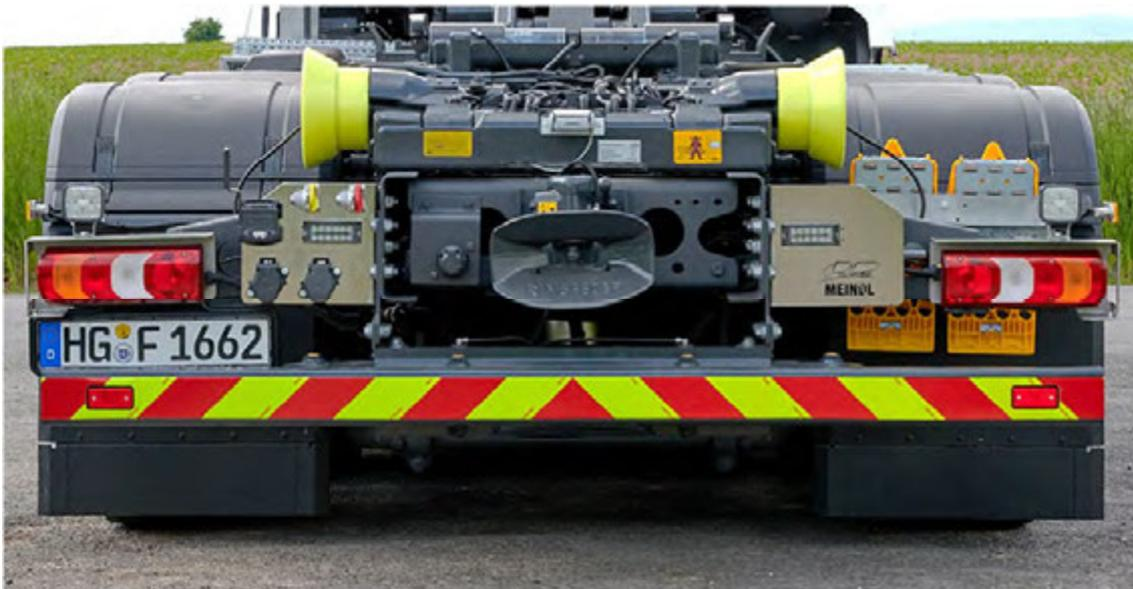
Abbildung 64: Fahrzeugmarkierung (hier Heckmarkierung gelb, schraffiert).
