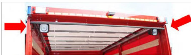
Abbildung 39: LED-Arbeitsstellenscheinwerfer im Heckportal, schwenkbar.
