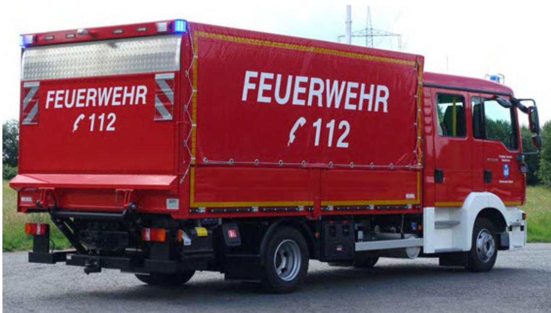
Abbildung 2: GW-L1 Ausführung Pritschenaufbau mit Plane.
