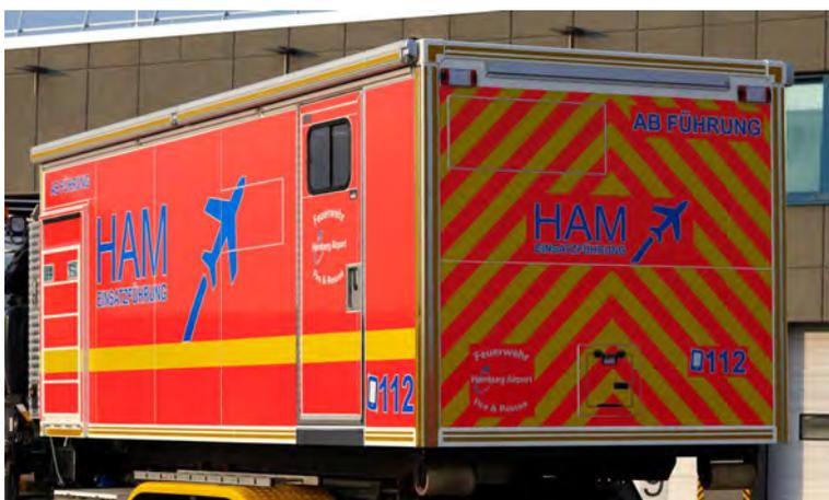
Abbildung 62: Heckschraffur-Kennzeichnung, seitliche Konturmarkierung, Beschriftung nach Vorgabe.
