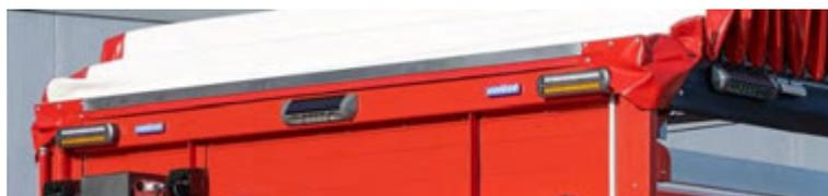
Abbildung 31: Frontblitzer, hier bei Planenausführung mit Schiebedachanlage.
