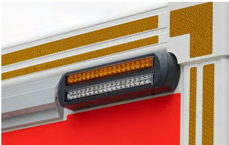
Abbildung 30: Die Positions- und Blinkleuchten sind separat schaltbar.
