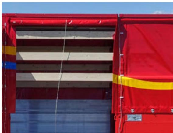
Abbildung 22: Rollplane geöffnet / geschlossen.
