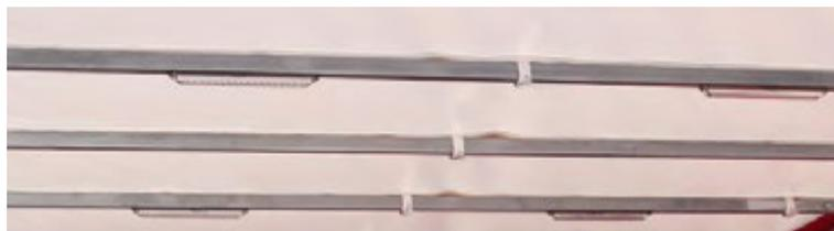
Abbildung 40: LED-Laderaumbeleuchtung (hier bei Ausführung Planendach).
