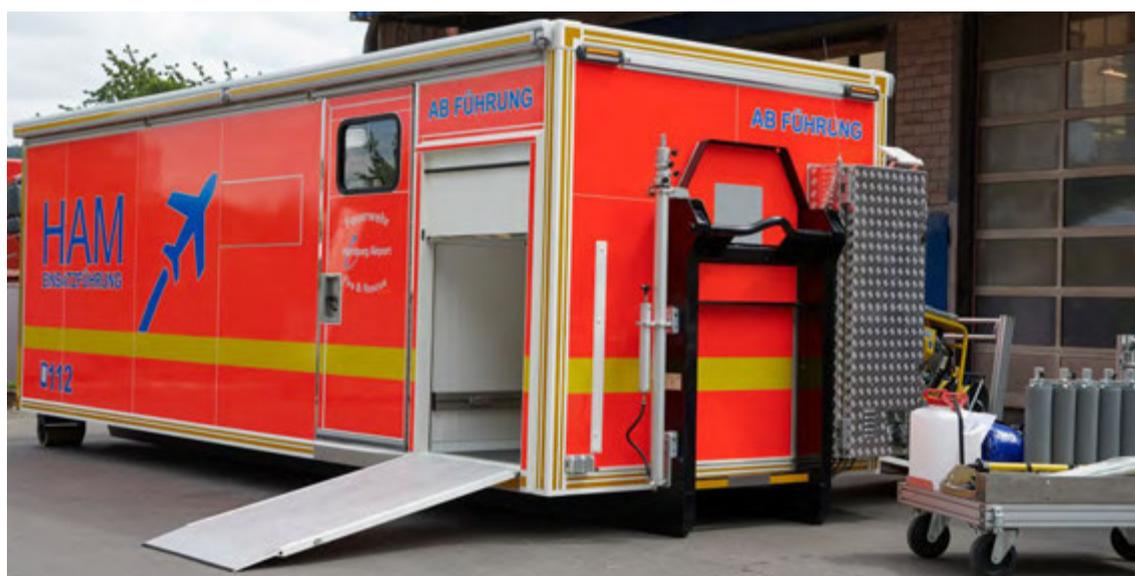
Abbildung 8: Geräteraumverschluss mit Rampe (hier länger als die Geräteraumhöhe ausgeführt, dadurch wird eine geringere Auffahrsschräge erreicht).
