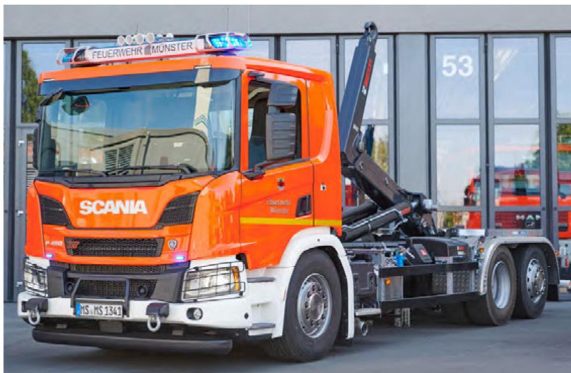
Abbildung 9: WLF 26/6900 auf SCANIA-Fahrgestell, Dachwarnbalken mit MEINDL-Edelstahl-Astschutz.
