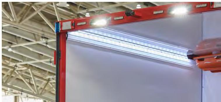
Abbildung 41: LED-Laderaumbeleuchtung (hier bei Ausführung Kofferaufbau).
