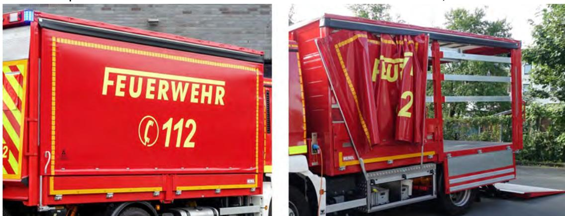
Abbildung 23: Seitenschiebepane geschlossen / geöffnet.
