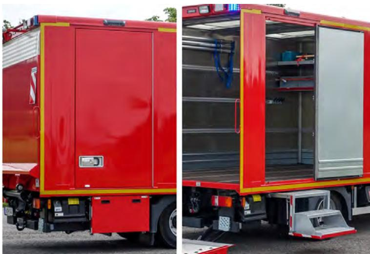
Abbildung 60: Seitentür hinten rechts (hier bei Kofferaufbau).
