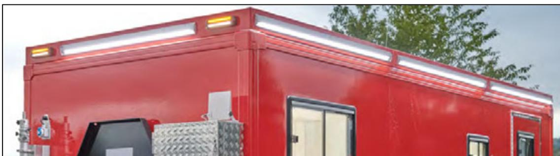
Abbildung 54: Dachgalerie umlaufend (hier mit Umfeld- und Positionsbeleuchtung).
