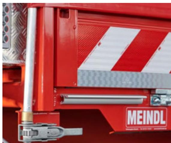
Abbildung 21: Spannvorrichtung der Seitenplanen.
