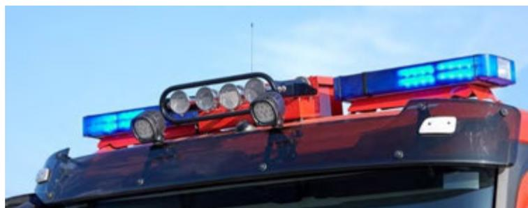
Abbildung 52: LED-Arbeitsstellenscheinwerfer vorne oben am Fahrerhaus.
