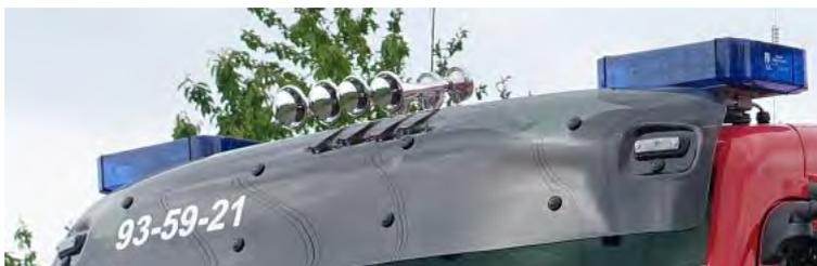
Abbildung 29: Geteilter Warnbalken, Hänsch DBS 975 LED mit Zusatz-Blitzern.
