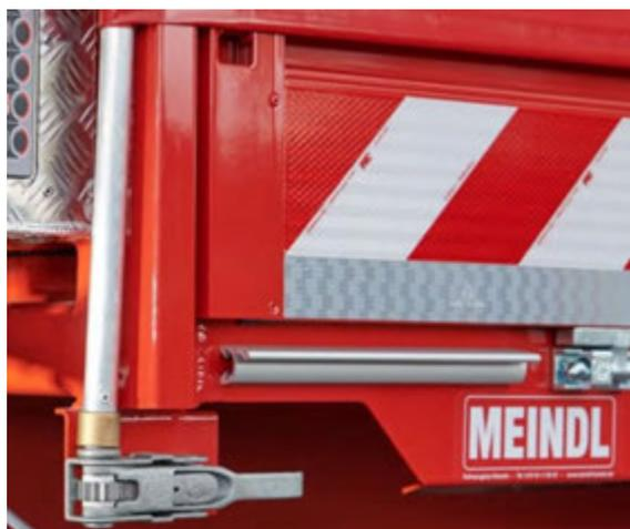
Abbildung 21: Spannvorrichtung der Seitenplanen.
