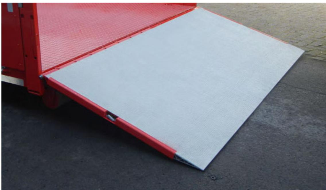
Abbildung 12: Detail – Auffahrrampe Rutschfestigkeitsklasse >R11.
