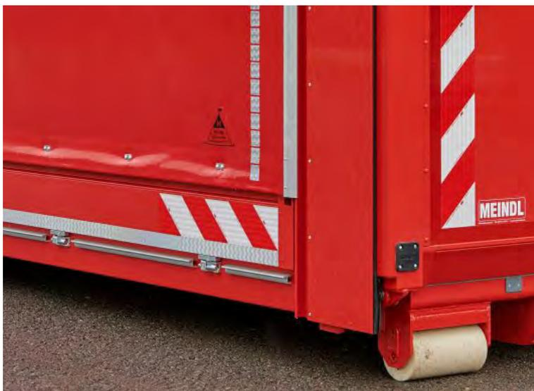
Abbildung 49: Kontur- und DIN-Warnmarkierung.
