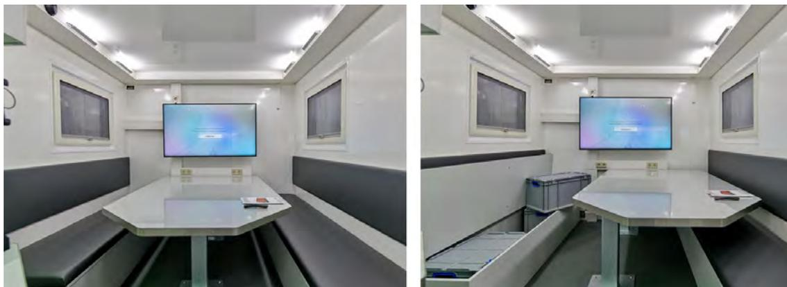
Abbildung 45: MEINDL-Besprechungstisch, verschiebbare Tischplatte für besseren Zugang.
