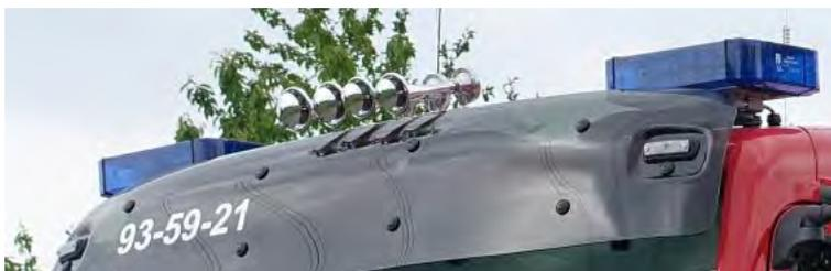
Abbildung 43: Geteilter Warnbalken, Hänsch DBS 975 LED mit Zusatz-Blitzern.
