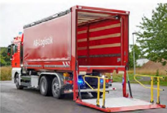
Abbildung 2: Öffnen des Vertikalliftes – Betrieb auf einem WLF 26/6900.
