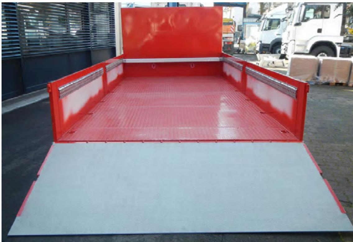
Abbildung 11: Detail – Auffahrrampe abgeklappt, Ladeflächenboden in Stahl-Warzenblech.
