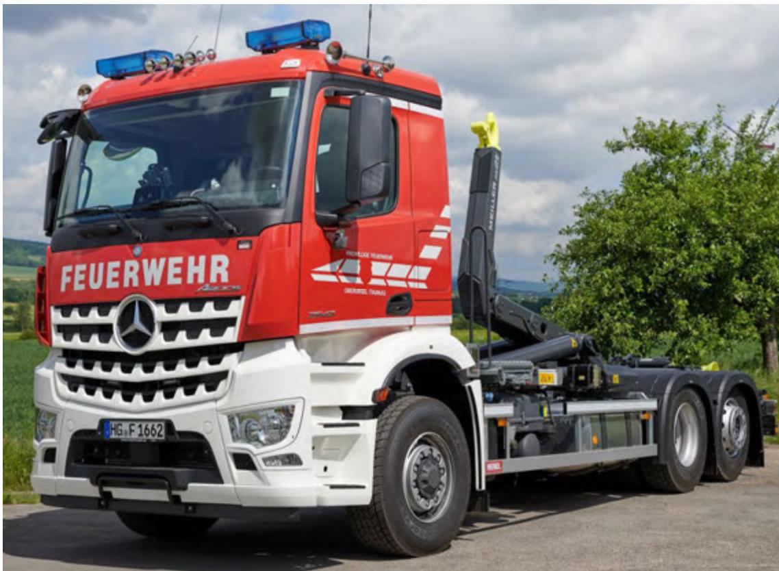
Abbildung 12: WLF 26/6900 auf Mercedes-Benz Arocs-Fahrgestell mit HAD (1. Achse hydraulisch angetrieben).
