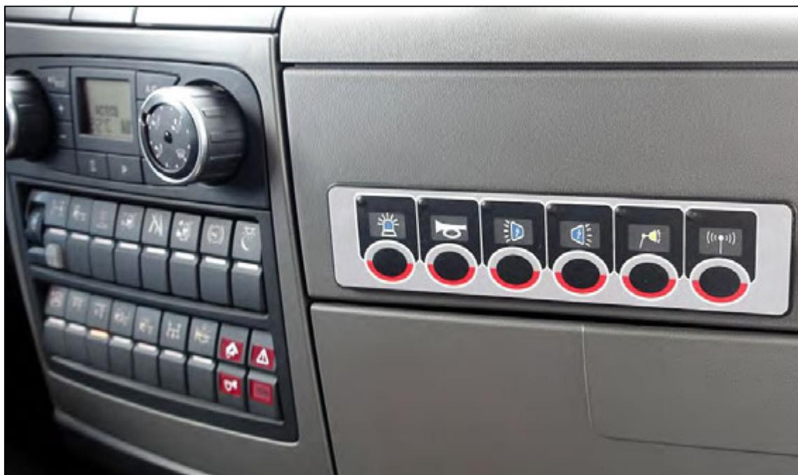
Abbildung 17: Detail – WLF Standard-Bedienteil für MEINDL CAN-BUS-System in der Armaturentafel integriert.
