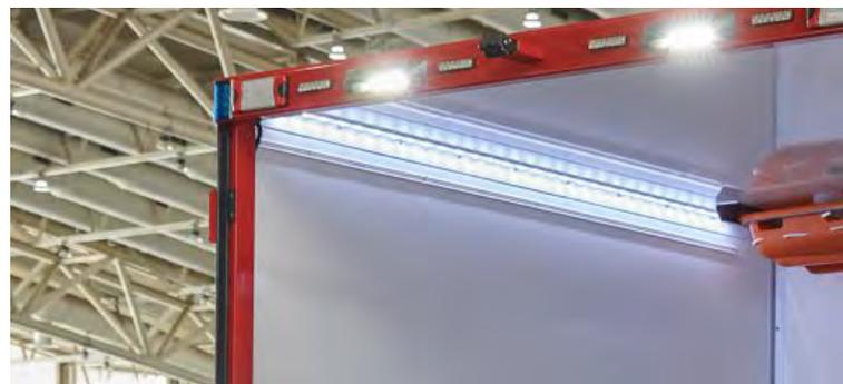
Abbildung 65: LED-Laderaumbeleuchtung (hier bei Ausführung Kofferaufbau).
