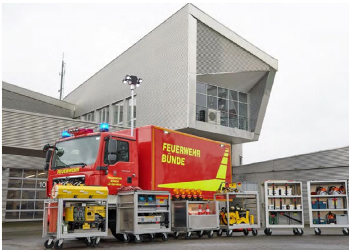
Abbildung 18: GW-L2 Sonderausführung mit darin verlasteten MEINDL-Rollcontainern.
