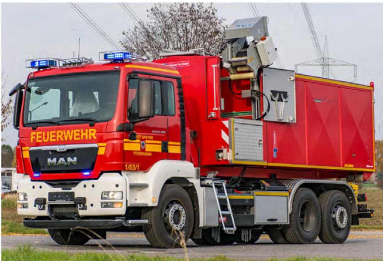
Abbildung 4: WLF 26/6900 auf MAN TGS-Fahrgestell, WLF-Ausstattung passend für Hytrans® Fire System-Behälter.
