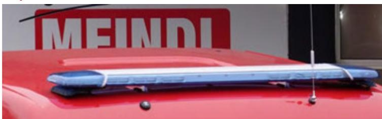
Abbildung 30: Warnbalken Hänsch DBS 5000 LED in besonders niedriger Bauhöhe.
