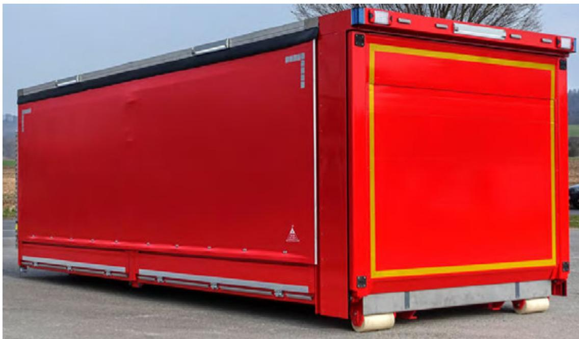
Abbildung 3: Ausführung mit seitlicher Schiebeplane.
