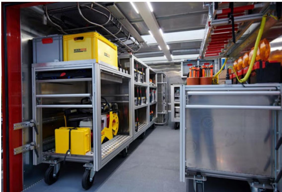
Abbildung 6: Anordnung MEINDL-Rollcontainer im GW-L verlastet. Hier in U-Anordnung mit Mittelgang, dadurch ist die Beladung aller Rollcontainer zugänglich.
