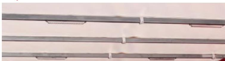
Abbildung 41: LED-Laderaumbeleuchtung (hier bei Ausführung Planendach).
