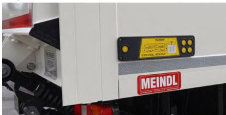
Abbildung 33: Komfort-Bedienteil, hochgesetzt.
