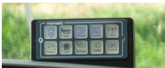
Abbildung 39: Standard-Bedienteil GW-L2.
