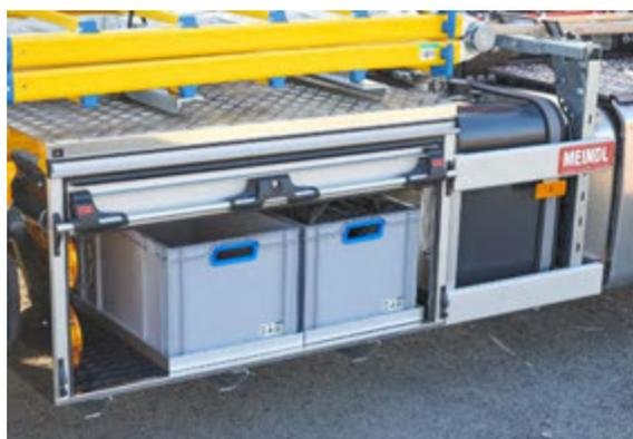
Abbildung 58: Staukasten – Edelstahl mit Alu-Rollladen.
