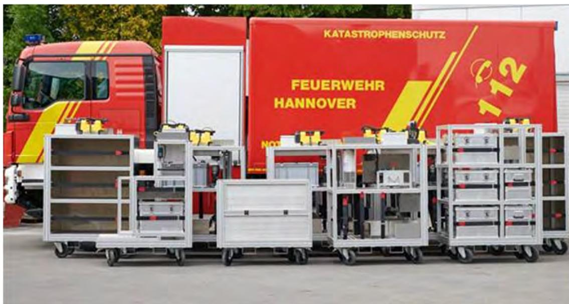
Abbildung 5: Im GW-L2 verlastete MEINDL-Rollcontainer. Durch komplette Zeichnungen inklusive Halterungen für die Beladung können Rollcontainer 1:1 nachbestellt werden. Ein Anpassen an die Beladung ist dabei nicht erforderlich.
