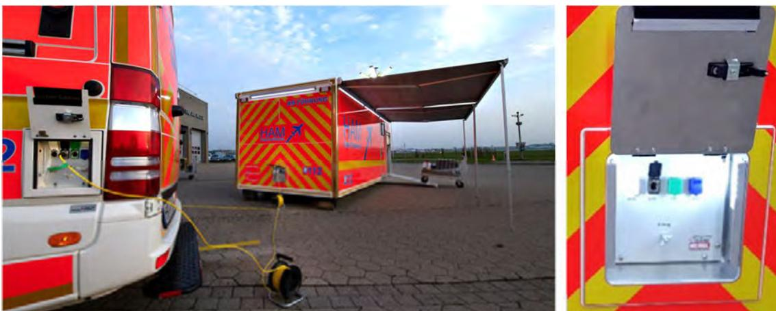
Abbildung 47: Verbindung ELW-1 zu AB Führung, Detail – MEINDL-Übergabeeinheit.
