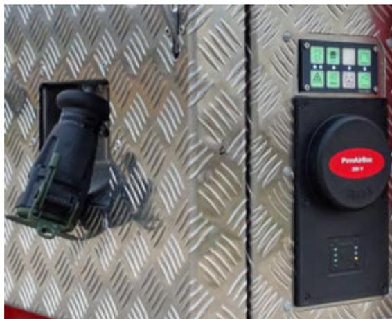
Abbildung 34: Stromeinspeisung PowAirBox, alternatives Bedienteil inomatic®.
