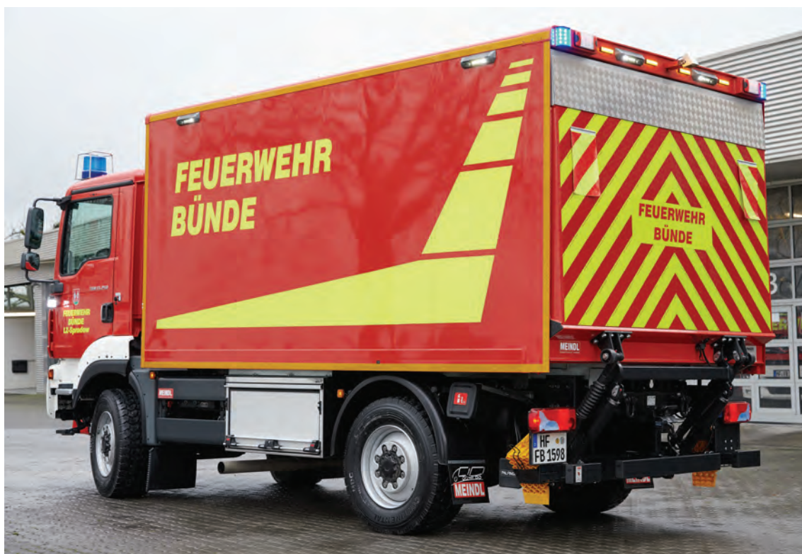
Abbildung 15: Detail – Heckportal „normalhoch“, Edelstahl-Staukasten mit Aluminium-Rollladen.
