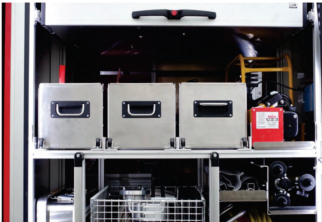
Abbildung 34: Detail – Facheinteilung, rollengelagerte Entnahmekästen mit Ausfallsicherung.
