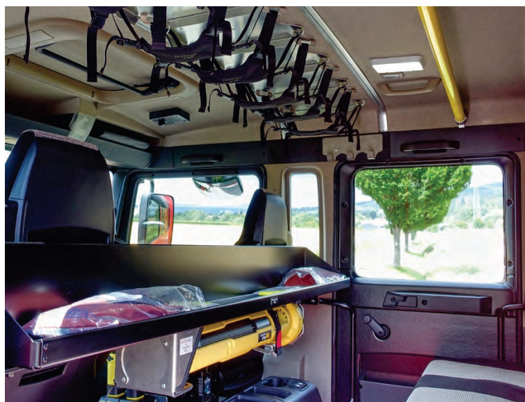
Abbildung 96: Ausbau – Mannschaftsraum: Helmhalter, Ablagen, Kleiderhaken, Griffstangen, Zusatz-Beleuchtung.
