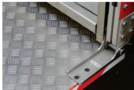
Abbildung 50: Zugangsklappe zum tiefgezogenen Geräteraum.
