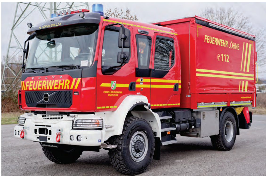
Abbildung 5: GW-L2 auf VOLVO FL 4x4-Fahrgestell mit Staffelkabine, Ausführung Pritschenaufbau mit Schiebeplane, Edelstahl-Unterflurkasten. Hänisch NOVA LED, MARTIN-HORN®-Anlage im MEINDL-Dachkasten. LDR-Umfeldbeleuchtung oben am Pritschenaufbau sowie Labcraft Scenelite S16 am Fahrerhaus oben zwischen den Türen.
