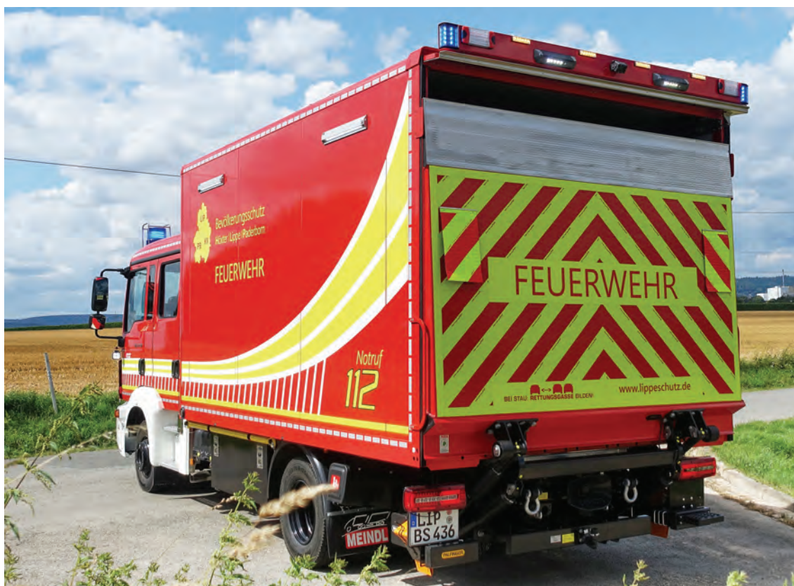
Abbildung 13: Heckportal mit automatisch zwangsgesteuerter Konsole. Die Heckkonsole öffnet und schließt automatisch in Abhängigkeit von der Ladebordwand.
