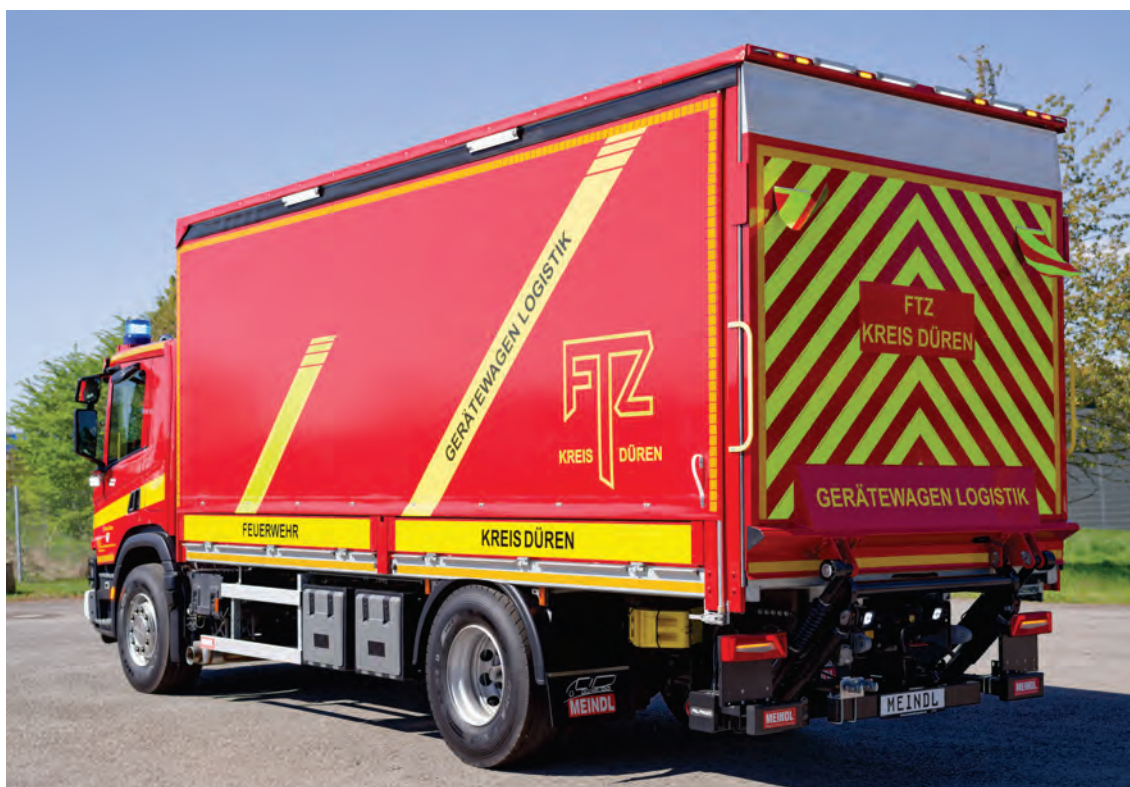
Abbildung 8: Detail – Unterbau verzinkt, ohne Lackierung, Heckportal in niedriger Ausführung – für eine maximal große Durchgangshöhe. Unser neues spezielles Heckportal ermöglicht eine größere lichte Durchgangshöhe als klappbare Heckkonsolen!
