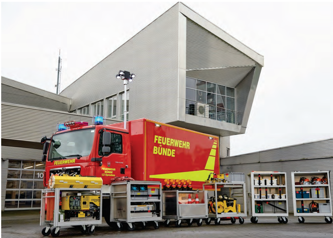
Abbildung 39: GW-L2 Sonderausführung mit darin verlasteten MEINDL-Rollcontainern.
