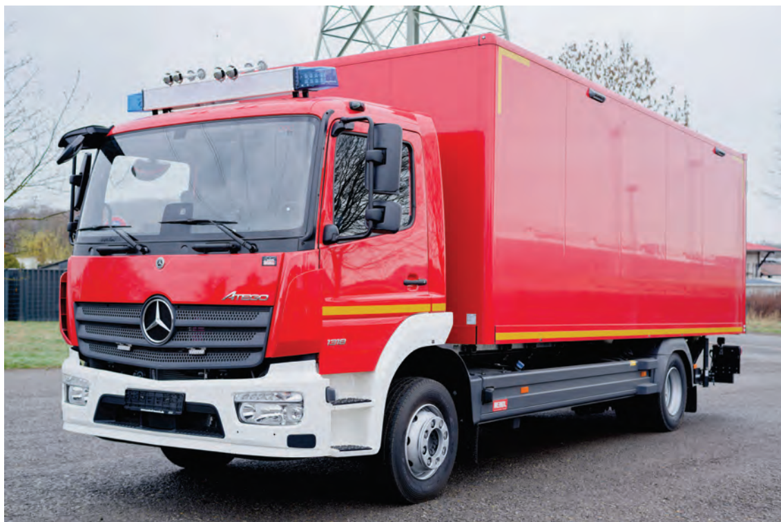
Abbildung 16: GW-L auf Mercedes-Benz Atego 4x2-Fahrgestell. Kofferaufbau (hier FerroFoam®-Bauweise). Warnbalken Hänsch DBS 2000 LED mit integrierter MARTIN-HORN®-Anlage, Labcraft Scenelite S16-Umfeldbeleuchtung.
