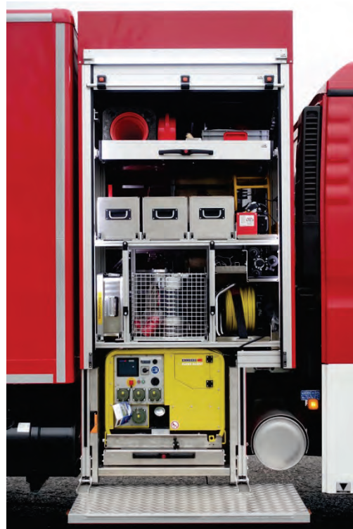
Abbildung 31: Detail – Beispiel G2 für Beladung nach DIN.
