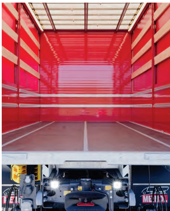
Abbildung 10: Detail – Meindl-Ladungssicherungspaket mit Schwerlast-Bodenzurrpunkten, 2 Reihen Seiten- und Stirn-wandzurrleisten sowie 3 Reihen Boden- und Dach-Sicherungsleisten.
