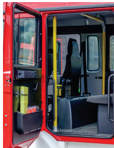
Abbildung 95: Ausbau Mannschaftsraum – Griffstangen.
