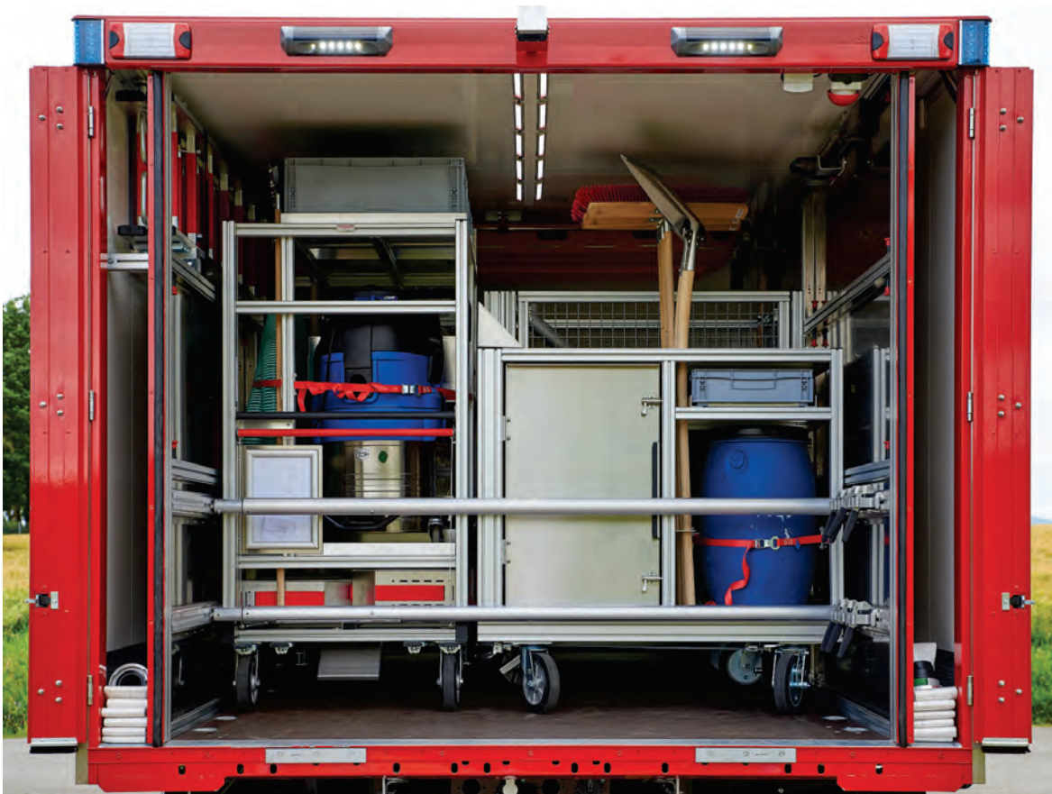
Abbildung 103: Schlauchdepot links und rechts je in einer doppelten Außenwand mit je einer separaten Hecktür.
