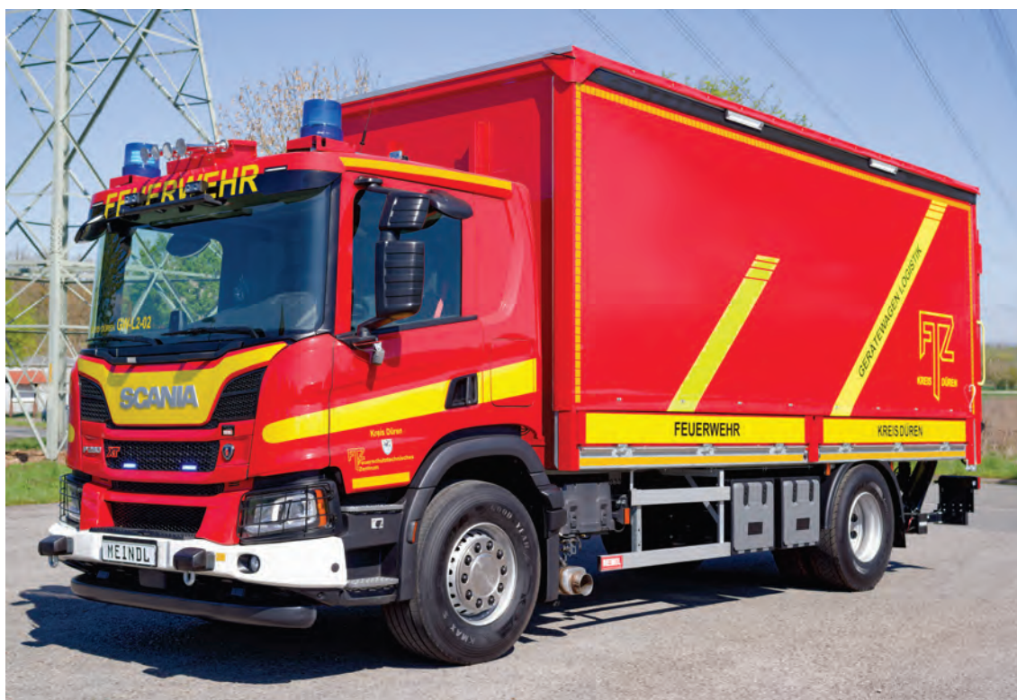
Abbildung 7: GW-L auf SCANIA-XT 4x2-Fahrgestell, Ausführung Pritschenaufbau mit Schiebep lane, Ladeflächenmaße ca. L x B x H = 6.200 x 2.440 x 2.375 mm.
