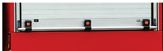
Abbildung 49: Geräteraumverschluss als durchgehende Griffstange, abschließbar.
