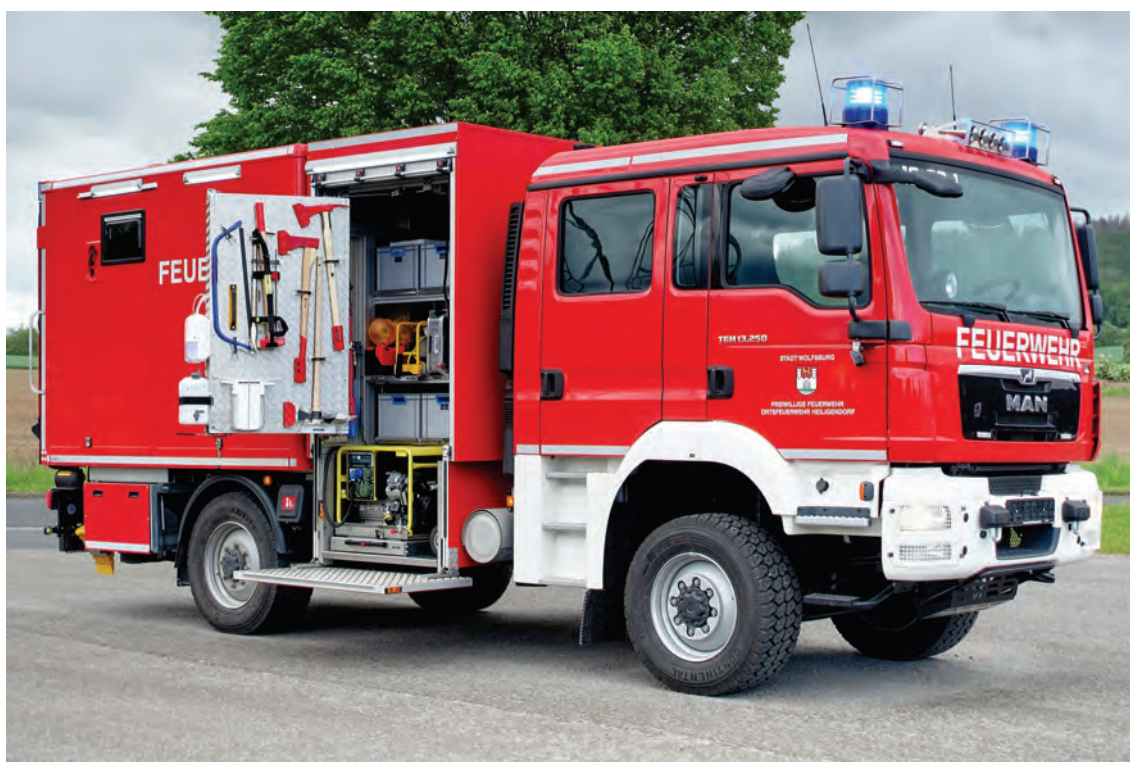
Abbildung 25: Detail – Geräteraum mit Schwenkwand und MEINDL-Schwerlastauszug. Hintere Seitentür mit Fenster, darunter ausziehbarer Klapptritt.
