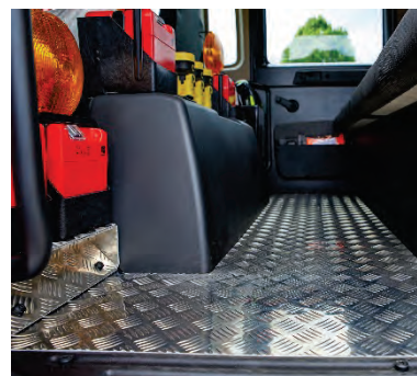
Abbildung 94: Ausbau Mannschaftsraum – Bodenverkleidung.
