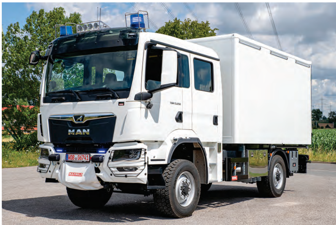
Abbildung 20: GW-L auf MAN TGM 4x4-Fahrgestell mit Staffelnkabine. Kofferaufbau (hier FerroFoam®-Bauweise). Elektrische MAXWALD-Frontseilwinde 24 V, 50 kN Zugleistung, Hänisch NOVA LED, MARTIN-HORN®-Anlage im MEINDL-Dachkasten, LDR-Umfeldbeleuchtung.
