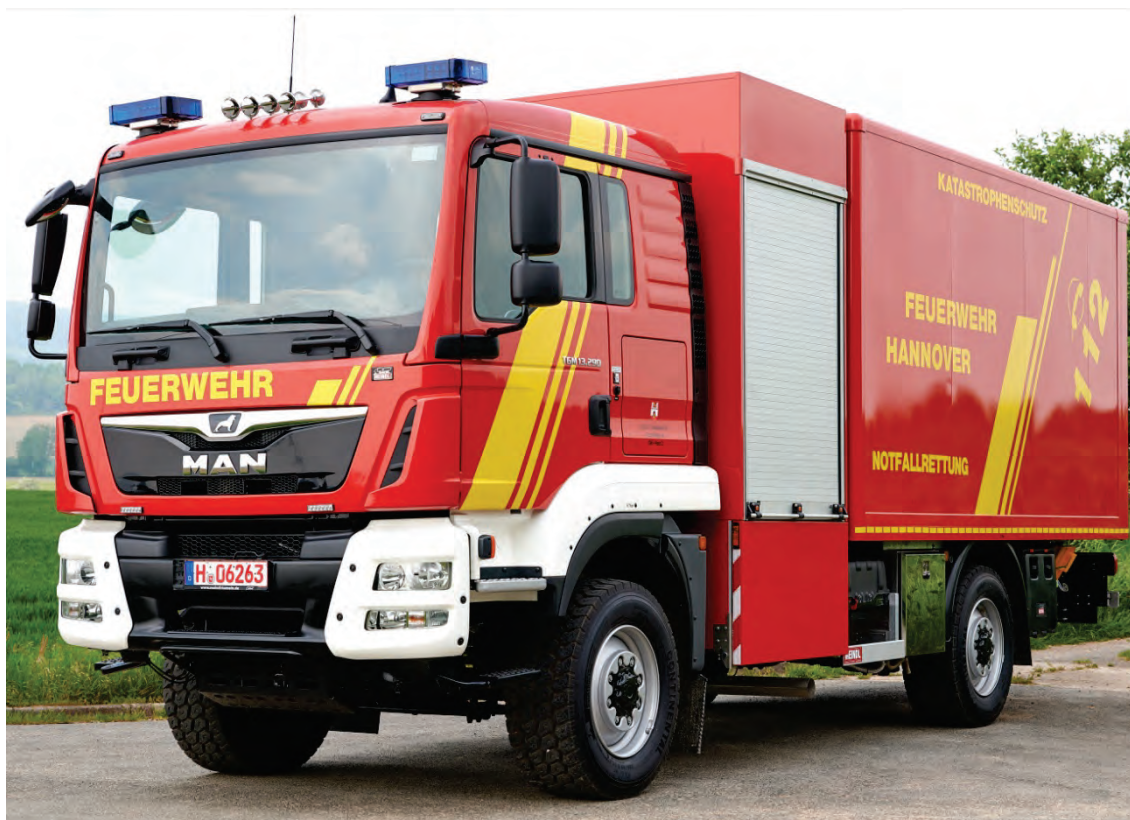
Abbildung 28: GW-L2 auf MAN TGM 4x4-Fahrgestell mit Truppkabine. Ausführung Kofferaufbau (hier Aluminium-Bauweise), tiefgezogener separater Geräteraum für höchste Geländetauglichkeit.
