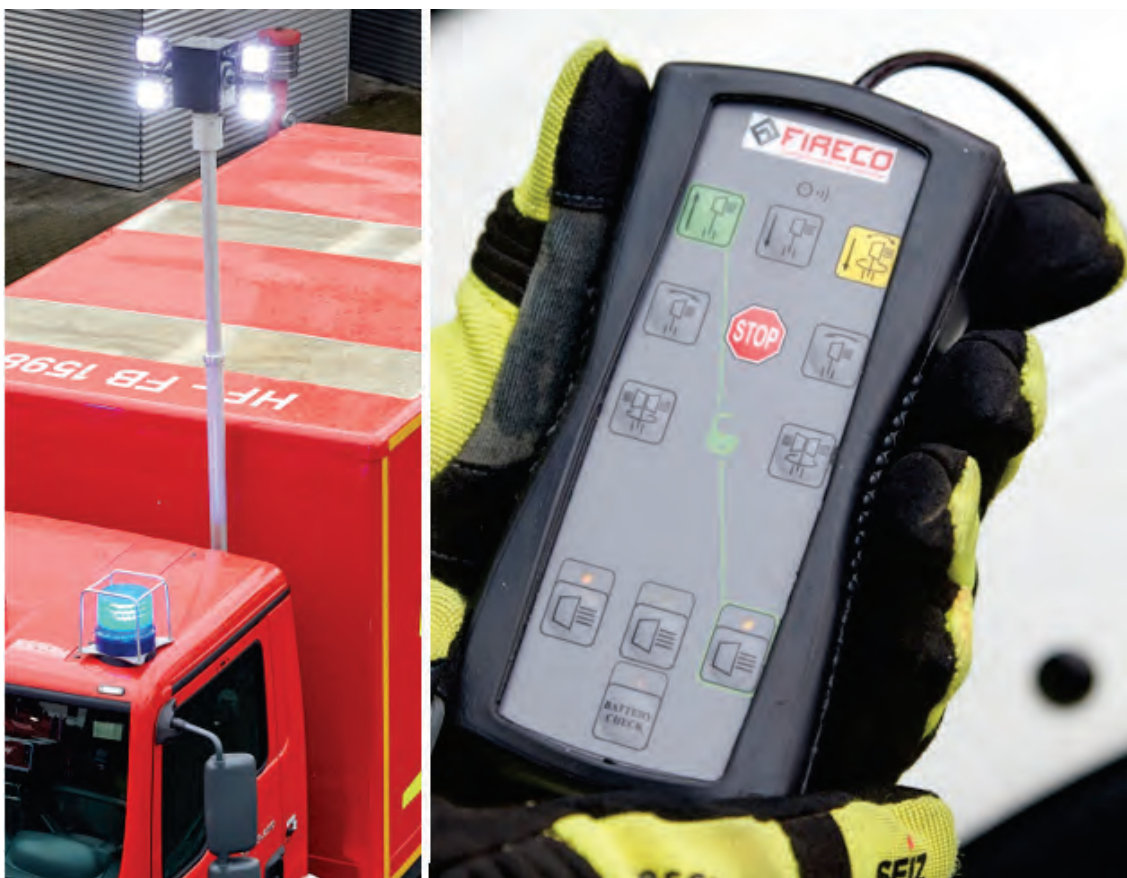
Abbildung 90: Lichtmast mit Fernsteuerung für alle Funktionen.
