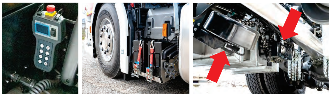
Abbildung 101: Links: Kabelfernsteuerung der ROTZLER TREIBMATIC TR 030. Mitte: Fahrzeugspezifische Halterungen für die Radkeile. Rechts: Platzsparend angeordnete Speichertrommel und Spillwindeneinheit.
