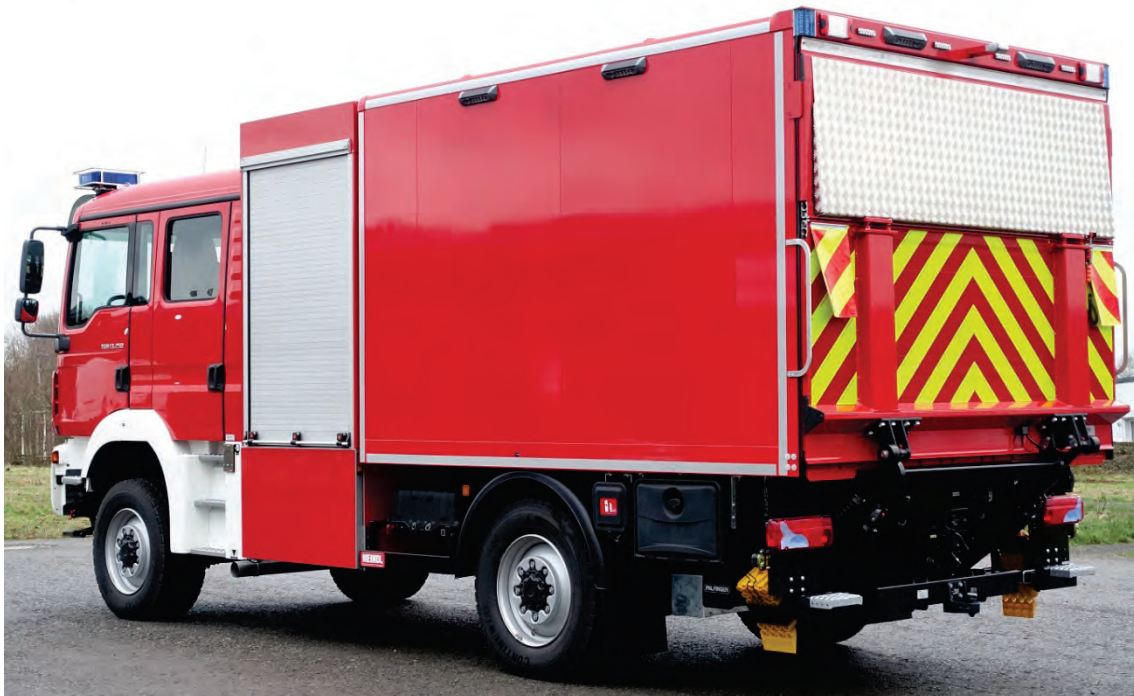
Abbildung 27: Detail – Ladebordwand horizontal geteilt, zum Verlegen von Schläuchen geeignet, optionaler Verschleißschutz an der Ladebordwand. Labcraft Scenelite S16-Umfeldbeleuchtung seitlich und hinten.
