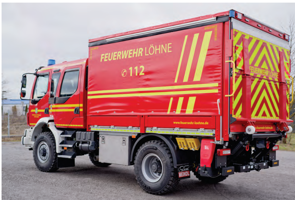
Abbildung 6: Detail – Unterbau verzinkt, ohne Lackierung, geteilte Ladebordwand zum Verlegen von Schläuchen, Heckportal „normalhoch“. Großzügig dimensionierte Auflagerollen der Ladebordwand.
