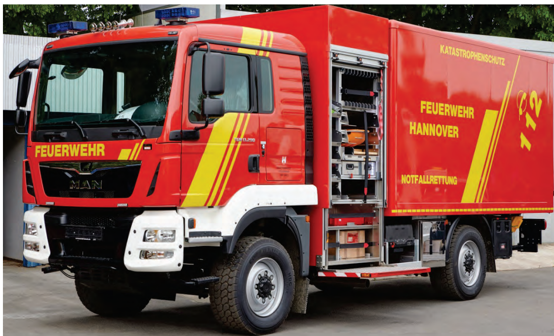
Abbildung 29: Detail – Rollladen-Geräteraum geöffnet und Auftrittfläche abgeklappt.
