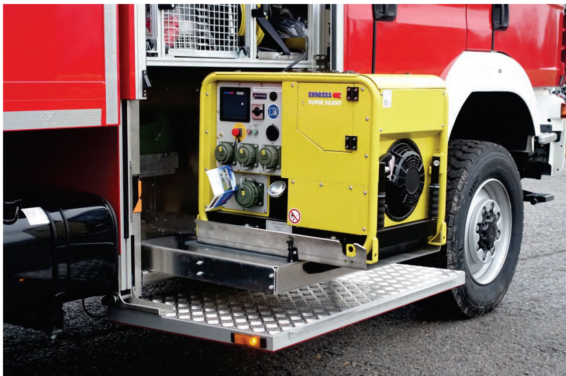
Abbildung 33: Detail – Generator auf MEINDL-Schwerlast-Schwenk-Auszug, Auftritt mit integrierten Warnleuchten.
