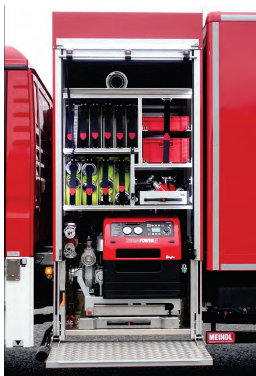
Abbildung 30: Detail – Beispiel G1 für Beladung nach DIN.
