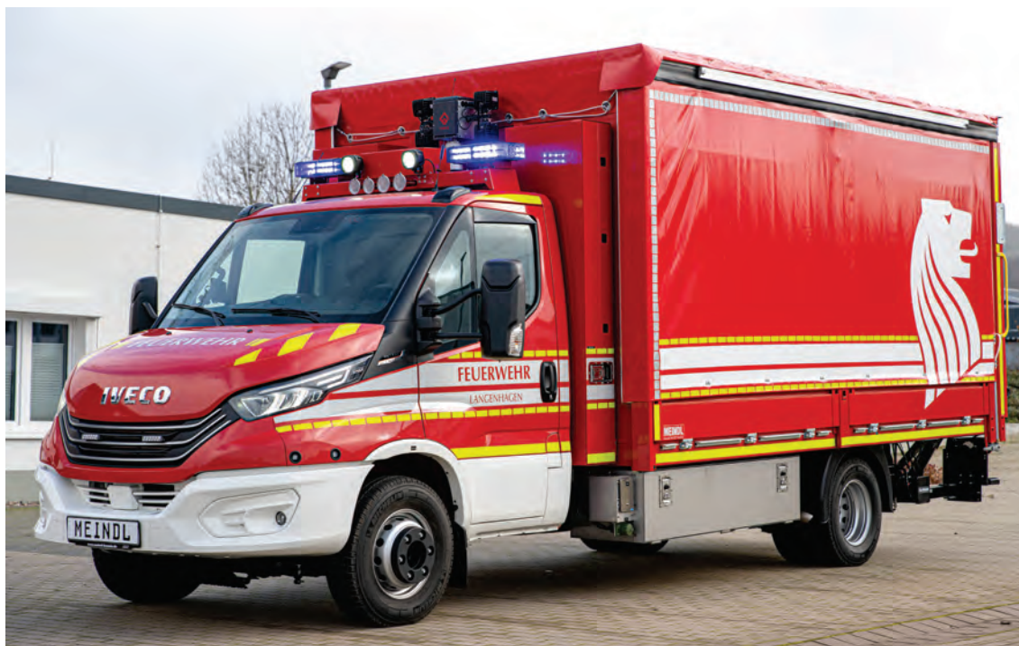
Abbildung 3: GW-L1 auf IVECO Daily 7,2-t-Fahrgestell. Ausführung Pritschenaufbau mit Schiebeplane. Optionale Ausstattung mit Lichtmast, 2 Stück Stauboxen zwischen Fahrerhaus und Aufbau sowie mit Edelstahl-Unterflurkästen.
