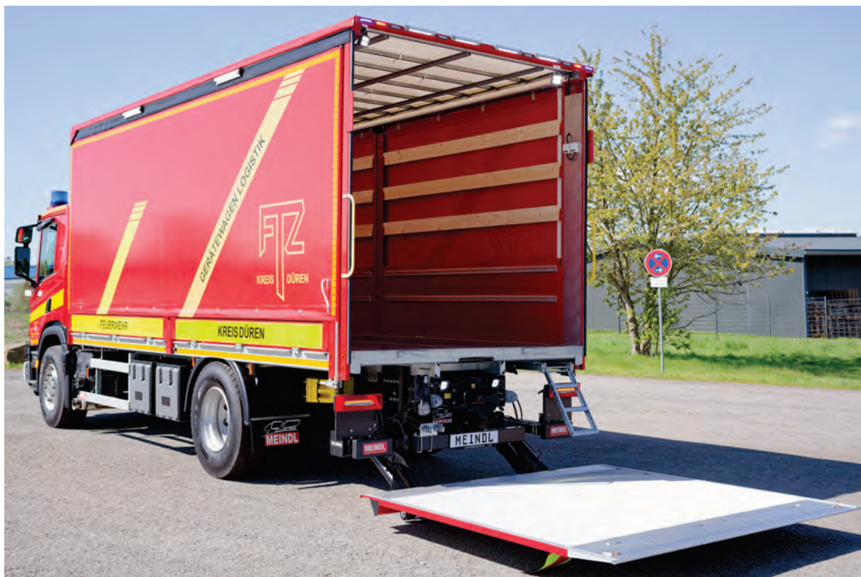
Abbildung 9: Durch das neue Heckportal in niedriger Ausführung ergibt sich eine maximale Durchladehöhe.
