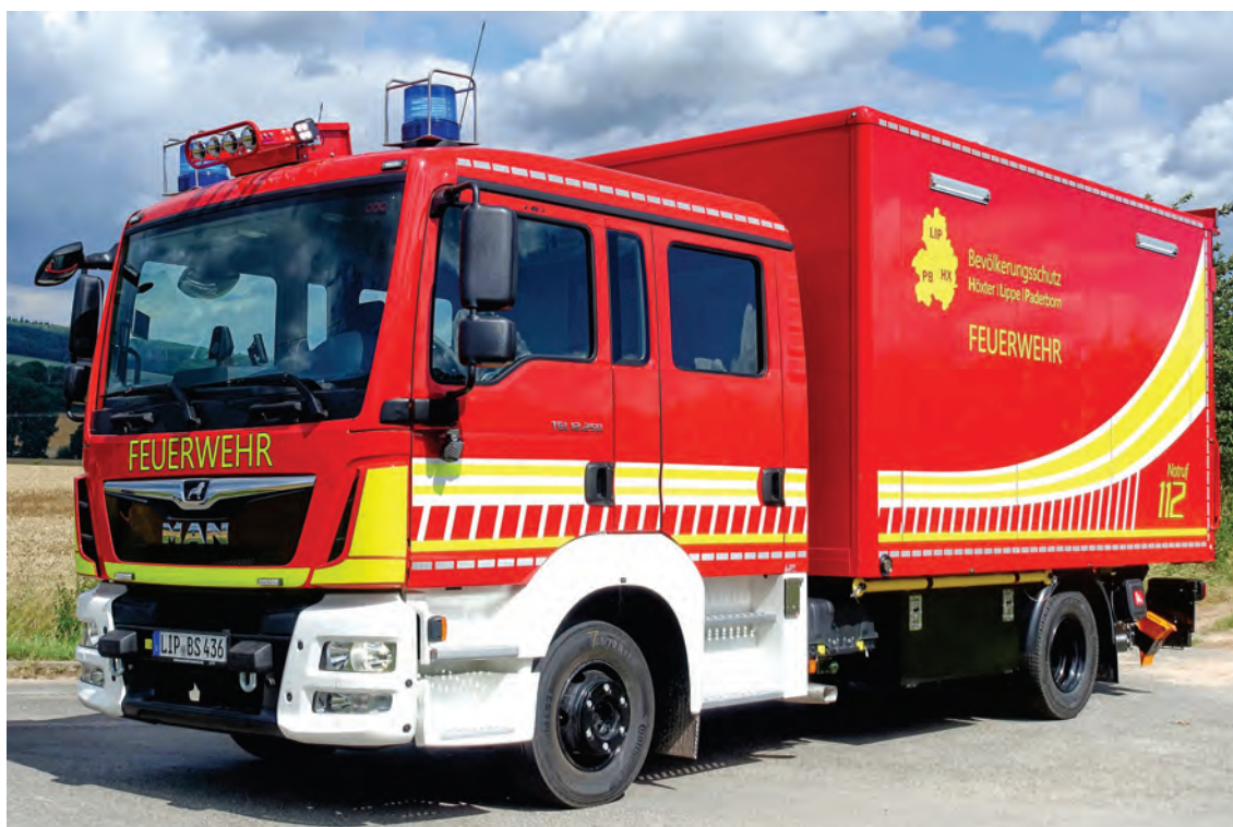
Abbildung 12: GW-L auf MAN TGL 4x2-Fahrgestell. Ausführung Kofferaufbau (hier FerroFoam®-Bauweise). Hänisch NOVA LED, MARTIN-HORN®-Anlage im MEINDL-Dachkasten, LDR-Umfeldbeleuchtung als Streifenelemente.
