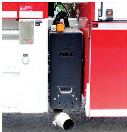
Abbildung 98: MEINDL-Batterieanlage mit Auszug.
