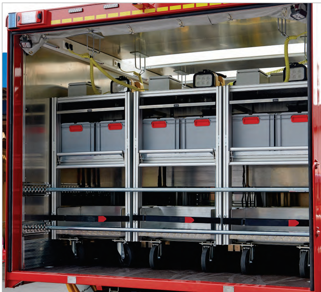
Abbildung 38: Detail – Laderaumbestückung, 230-V-Ladeanlage für in den Rollcontainern verlastete Geräte.
